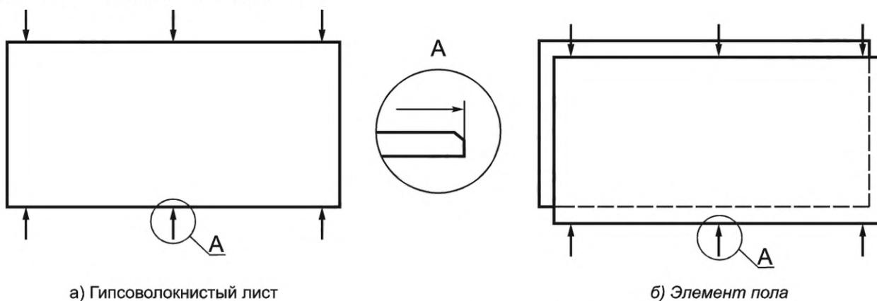
Рисунок 3 — Определение ширины
