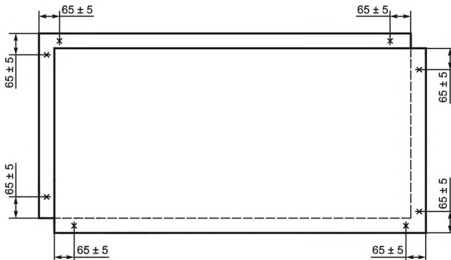
Рисунок 7 — Определение фальца элемента пола
