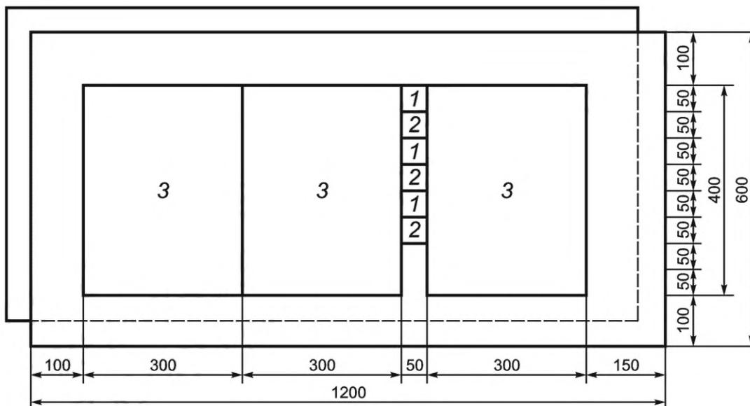
1 — образцы для испытания на прочность при сжатии по 5.15; 2 — образцы для испытания на прочность клеевого соединения по 5.16; 3 — образцы для определения влажности по 5.17
