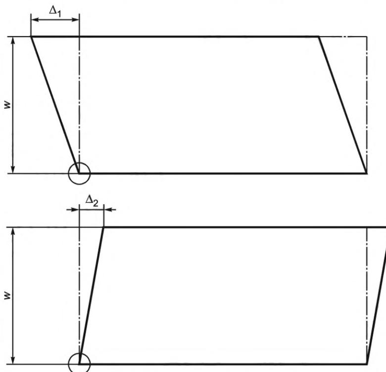
Рисунок 6 — Определение прямоугольности
