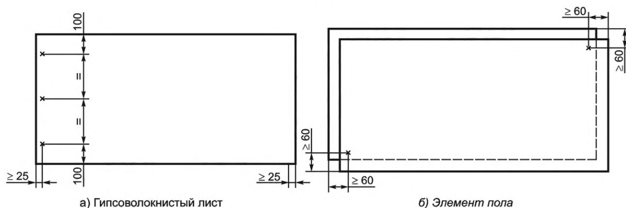
Рисунок 5 — Определение толщины
