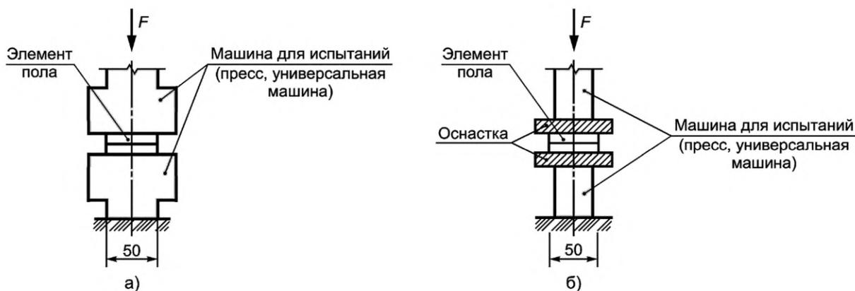
а) стандартный вариант; б) вариант с оснасткой (применяется, если площадь приложения нагрузки не перекрывает площадь образца)
