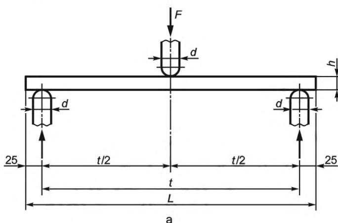
а — для образцов из плит номинальной толщины 25 мм включительно; б — для образцов из плит номинальной толщины свыше 25 мм;  $F$  — нагрузка;  $d$  — диаметр цилиндрической части опор и ножа;  $L$  — длина образца;  $h$  — толщина образца;  $t$  — расстояние между опорами
