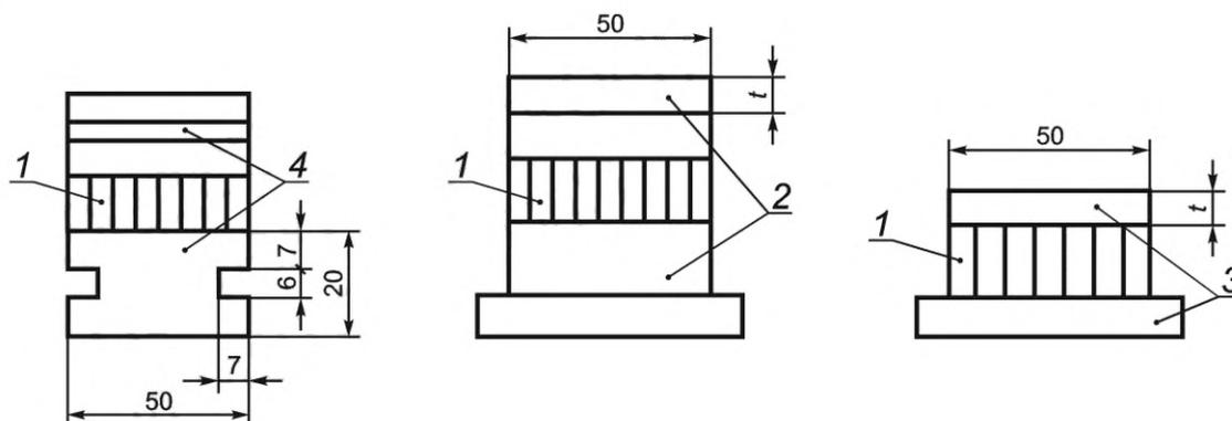
1 — испытуемый образец; 2 — испытательная колодка из металла, из твердой древесины или из фанеры из твердой древесины; 3 — испытательная колодка из твердой древесины или из фанеры из твердой древесины; 4 — испытательная колодка из металла
