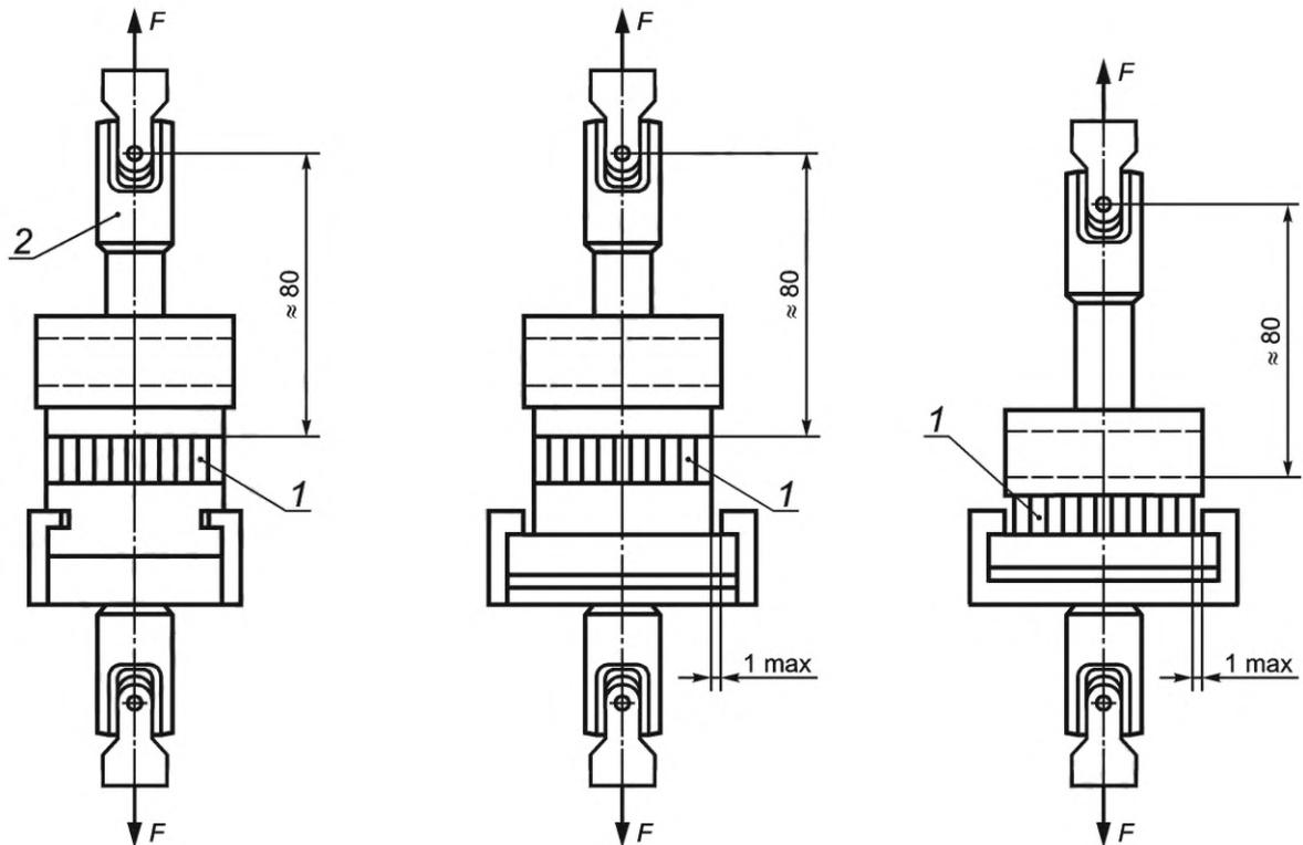
1 — испытуемый образец плиты; 2 — самоцентрирующееся устройство типа «карданный шарнир»;  $F$  — максимально разрушающая нагрузка
