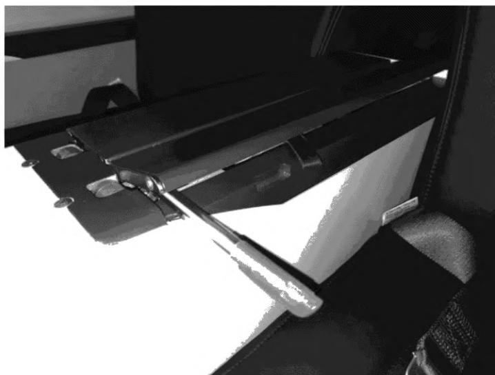
Рисунок Б.1 — Крышка подлокотника кресла со встроенным столиком (пример элемента с оценкой 1а по классификации таблицы 9)
