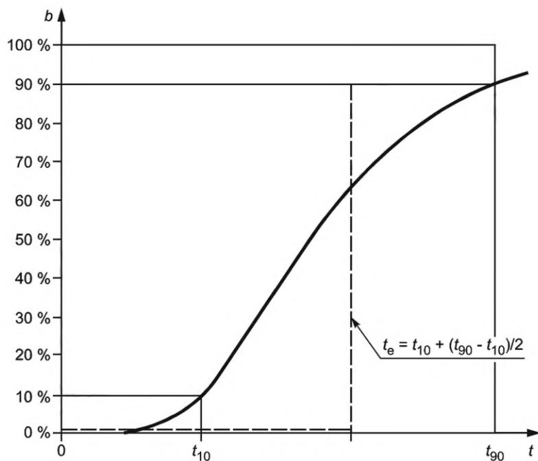
$t_{10}$  — время задержки;  $t_{90}$  — время срабатывания системы торможения
