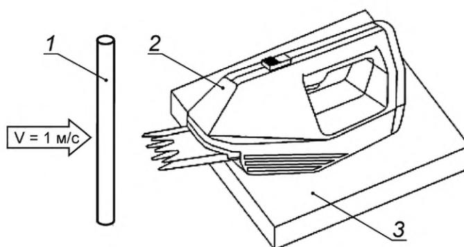
1 — медная трубка; 2 — газонные ножницы, закрепленные на стальной или бетонной основе;
