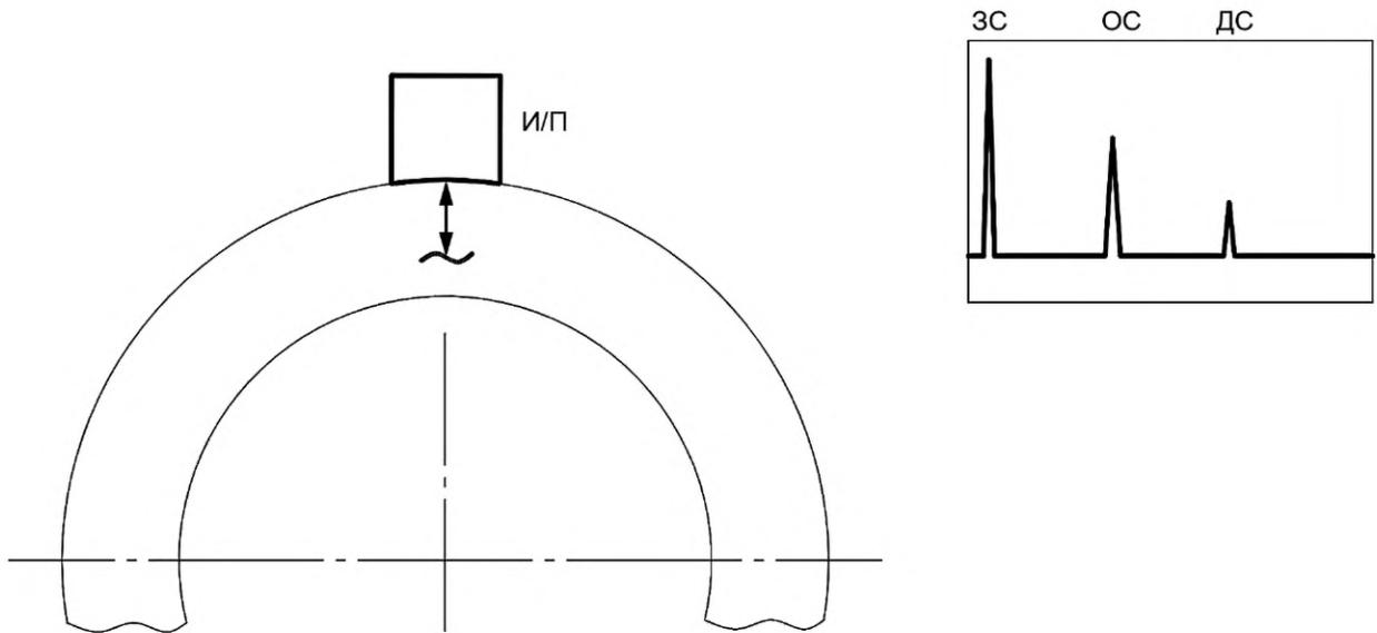
Рисунок А.3 — Эхо-импульсный метод контроля для выявления расслоений
