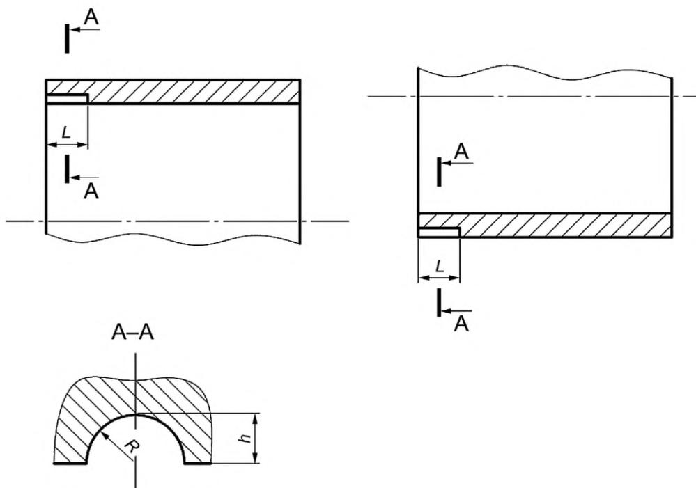
П р и м е ч а н и е — Настрочный образец рекомендуется при ручном контроле труб наружным диаметром свыше 50 мм и номинальной толщиной стенки более 5 мм.
