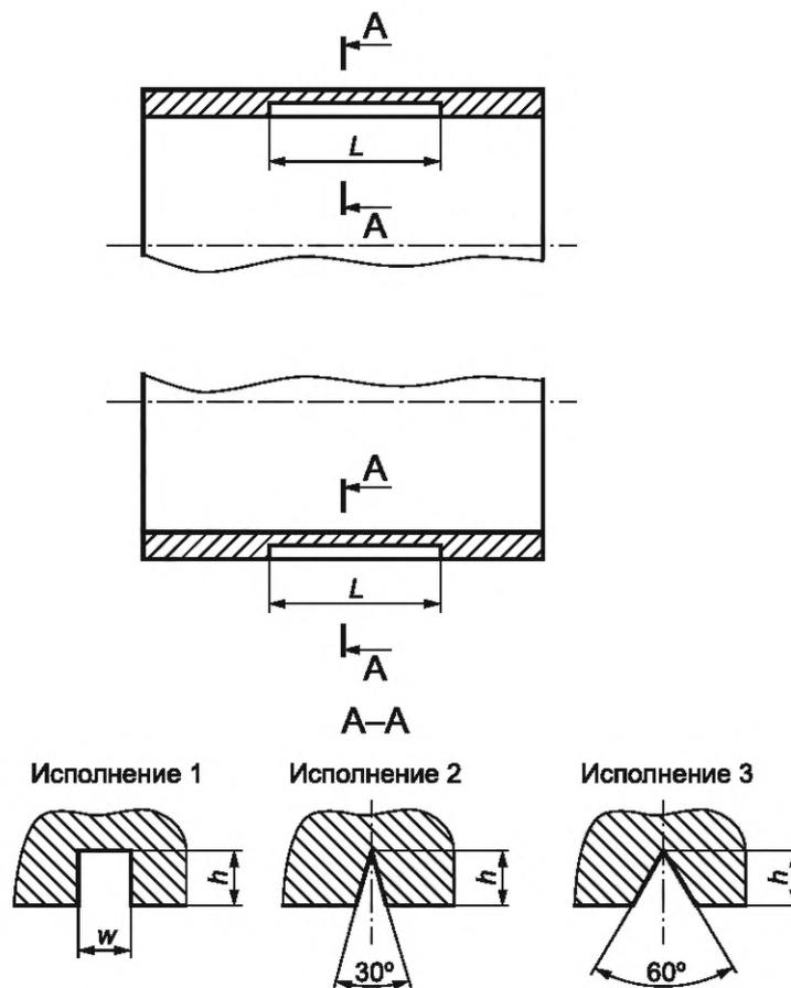
Примечание — Настраечный образец рекомендуется при автоматизированном и механизированном контроле:
