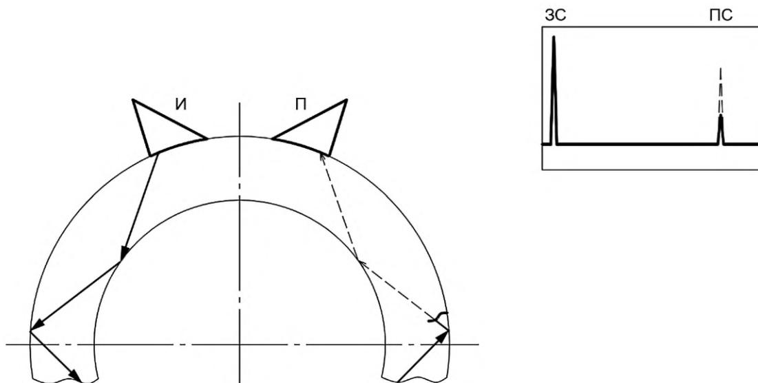
Рисунок А.8 — Теневой метод контроля по раздельной схеме для выявления продольных дефектов
