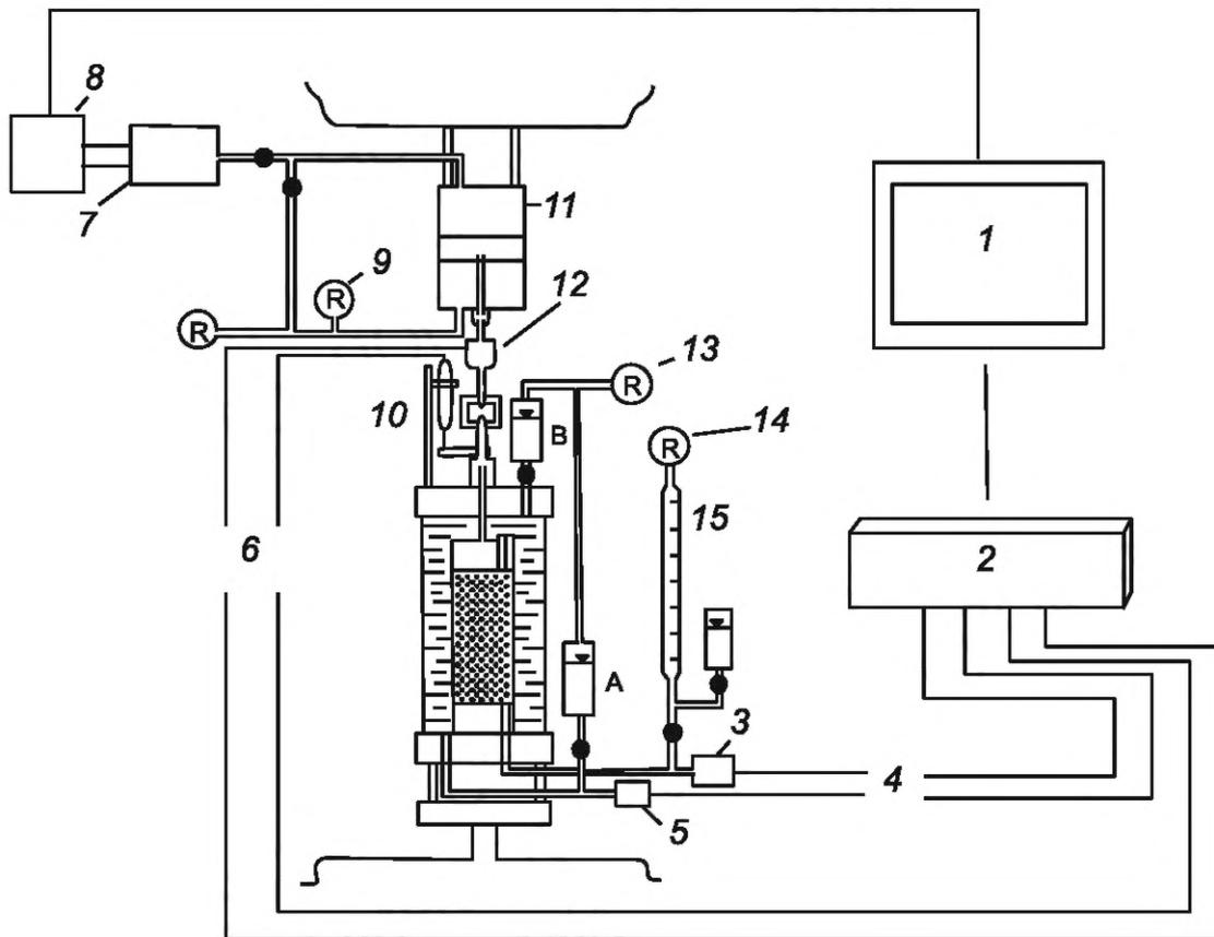
1 — управляющий компьютер; 2 — система сбора данных; 3 — датчик порового давления; 4, 6 — к системе регистрации; 5 — датчик давления в камере; 7 — электропневматический преобразователь; 8 — задающий генератор; 9 — регулятор противодействия; 10 — датчик осевых деформаций; 11 — пневмонагружатель двойного действия; 12 — датчик осевой нагрузки; 13 — регулятор давления в камере; 14 — регулятор обратного давления; 15 — бюрета
