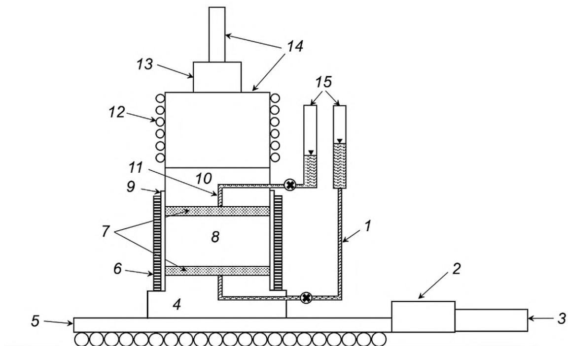
1 — нижний дренажный канал; 2 — горизонтальное силоизмерительное устройство; 3 — сдвиговой привод; 4 — основание; 5 — сдвиговая платформа; 6 — жесткие кольца (или армированная мембрана); 7 — фильтрующие диски; 8 — образец; 9 — латексная мембрана; 10 — штамп; 11 — верхний дренажный канал; 12 — направляющие осевой нагрузки; 13 — вертикальное силоизмерительное устройство; 14 — вертикальный привод; 15 — бюреты
