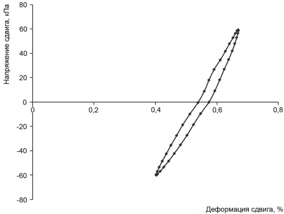
Рисунок М.1 — Пример деформирования грунта при крутильном сдвиге
