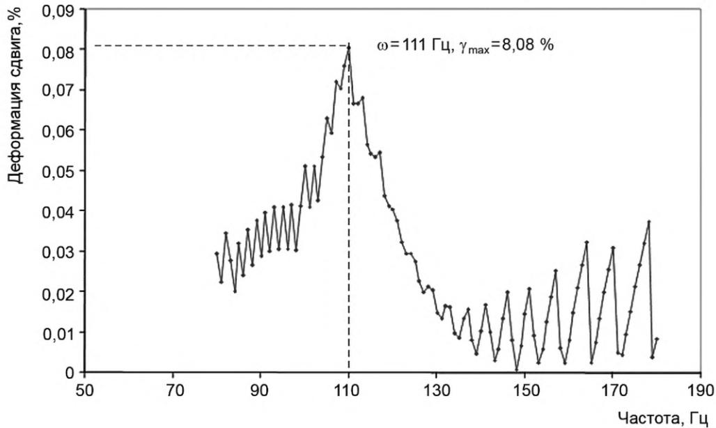
Рисунок Л.1 — Пример резонансной кривой образца грунта
