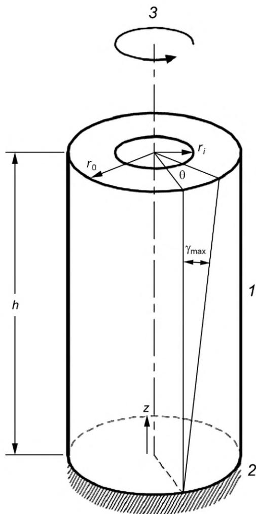
1 — образец грунта; 2 — фиксированный торец; 3 — крутящий момент;  $h$  — высота образца;  $r_0$  — внешний радиус образца;  $r_i$  — внутренний радиус полого образца;  $z$  — направление вертикальной оси;  $\gamma_{\max}$  — максимальное значение относительной деформации сдвига;  $\theta$  — угол перекоса образца при кручении
