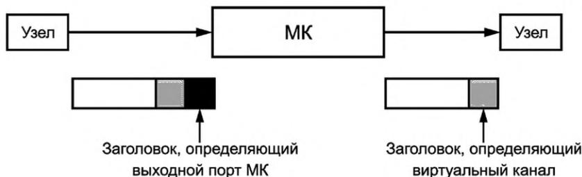
Рисунок Т.2 — Удаление заголовка
