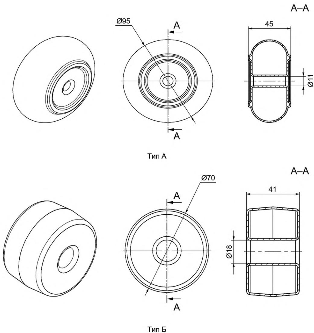
Тип А — поплавок для спортивной разделительной дорожки; тип Б — поплавок для произвольной разделительной дорожки
