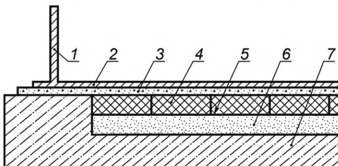
1 — стенка РВС; 2 — дно РВС; 3 — гидроизоляционный слой; 4 — теплоизоляционный материал;
