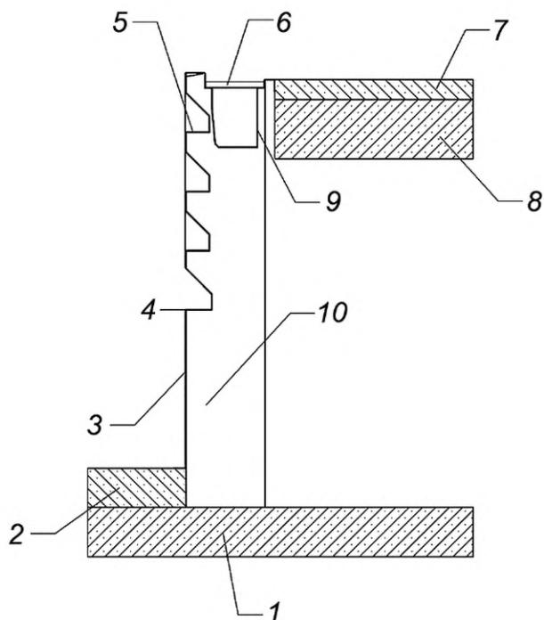
1 — бетонная плита фундамента; 2 — бетонная обвязка; 3 — борт ванны; 4 — уступ для отдыха; 5 — лестница; 6 — решетка переливного лотка; 7 — стяжка чистого пола; 8 — плиты перекрытия; 9 — лоток переливной; 10 — бетонная ванна
