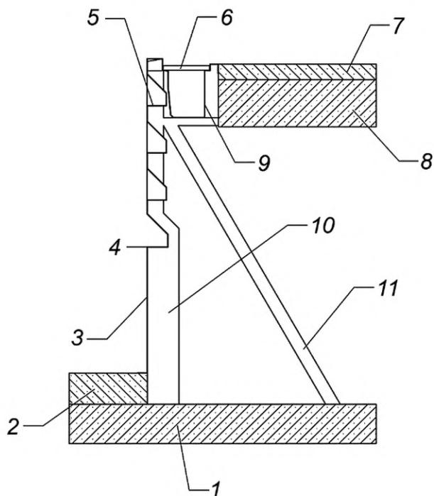
1 — бетонная плита фундамента; 2 — бетонная обвязка; 3 — борт ванны; 4 — уступ для отдыха; 5 — лестница; 6 — решетка переливного лотка; 7 — стяжка чистого пола; 8 — плиты перекрытия; 9 — лоток переливной; 10 — колонна; 11 — подкос
