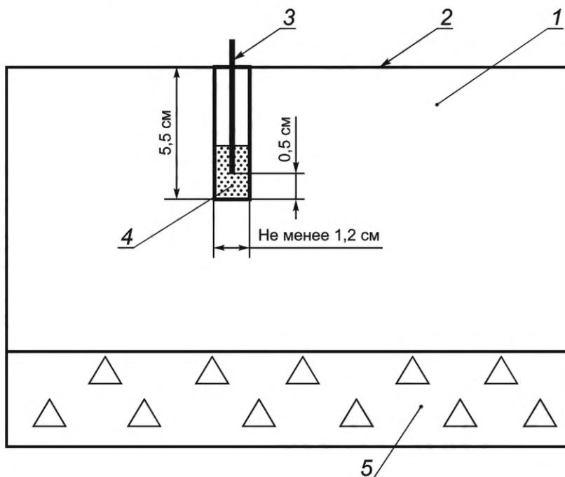
1 — слой асфальтобетона; 2 — поверхность покрытия; 3 — термометр; 4 — смесь глицерина и воды;
