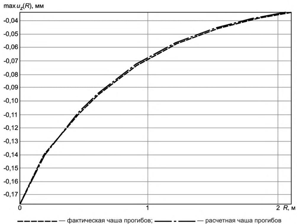
Рисунок Г.6 — Расчетная чаша прогибов, построенная с использованием математической модели, и фактическая чаша прогибов после корректировки
