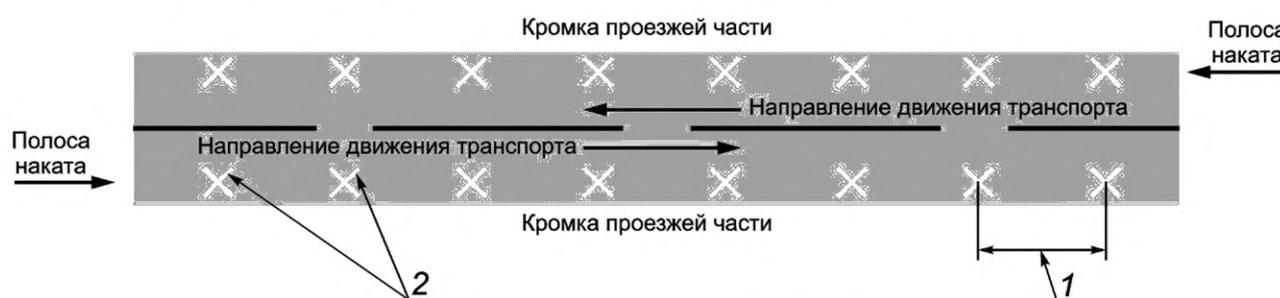
б) Места измерений на 2-полосной автомобильной дороге
