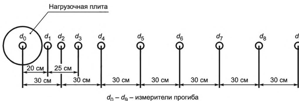
Рисунок 3 — Схема расположения измерителей прогиба, включая дополнительные измерители
