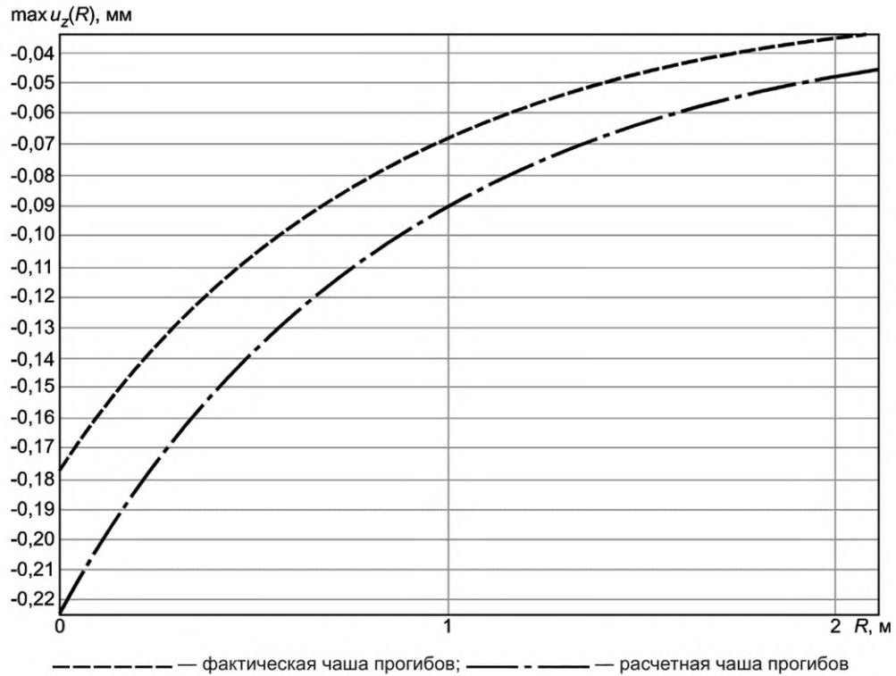
Рисунок Г.5 — Расчетная чаша прогибов, построенная с использованием математической модели, и фактическая чаша прогибов, построенная по результатам измерений
