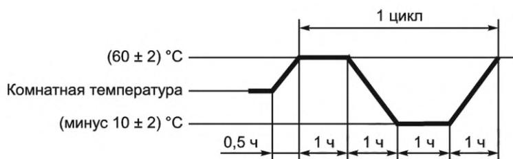
Рисунок 9 — Программа испытания на температурное циклирование
