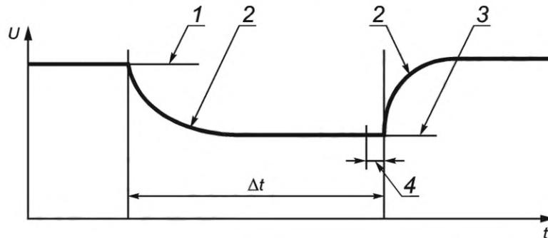
1 — напряжение разомкнутой цепи  $U_{p.ц}$  (НРЦ); 2 — эффект емкостного сопротивления; 3 — напряжение замкнутой цепи  $U_{з.ц}$  (НЗЦ); 4 —  $\Delta t'$  (измерение  $U_{з.ц}$ )
