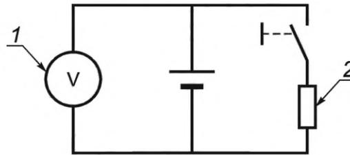
1 — отображение значений  $U_{з.ц}/U_{p.ц}$ ; 2 — измерительное сопротивление  $R_{и}$
