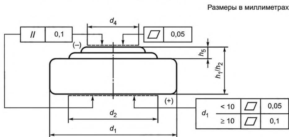
$h_1$  — максимальная общая высота батареи;  $h_2$  — минимальное расстояние между плоскостями положительного и отрицательного контактов;  $h_5$  — минимальный выступ плоскости отрицательного контакта;  $d_1$  — максимальный и минимальный диаметры батареи;  $d_2$  — минимальный диаметр плоского положительного контакта;  $d_4$  — минимальный диаметр плоского отрицательного контакта
