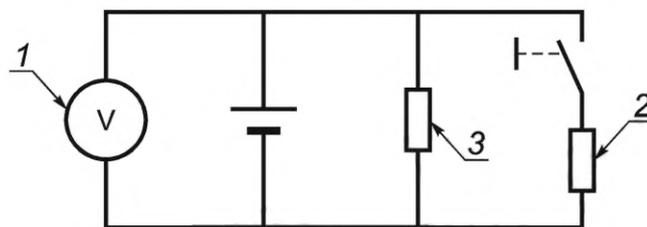
1 — отображение значений  $U_{\text{з.ц}}/U'_{\text{р.ц}}$ <sup>1)</sup>; 2 — измерительное сопротивление  $R_{\text{и}}$ ; 3 — сопротивление непрерывного разряда  $R_{\text{н.р}}$
