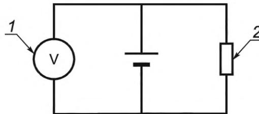
1 — отображение значений  $U_{3,ц}$ ; 2 — сопротивление непрерывного разряда  $R_{н.р}$
