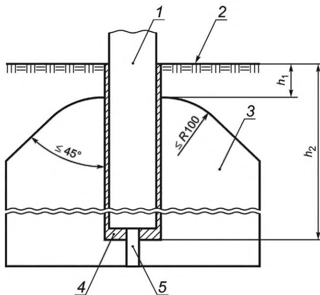
1 — стойка; 2 — поверхность игрового поля; 3 — бетонный блок; 4 — установочные гильзы;
