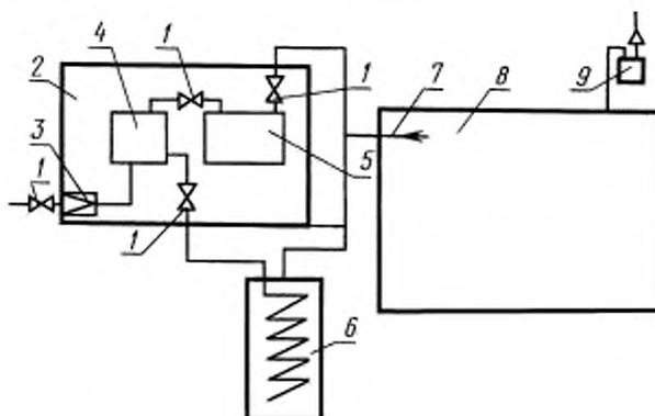
1 — двухходовой вентиль; 2 — камера испарителя; 3 — редуктор; 4 — ресивер; 5 — емкость испарителя;
