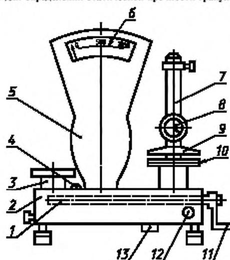
1 — рычажная система; 2, 5 — циферблатные весы; 3 — чашка весов; 4 — уровень; 6 — измерительная шкала;
