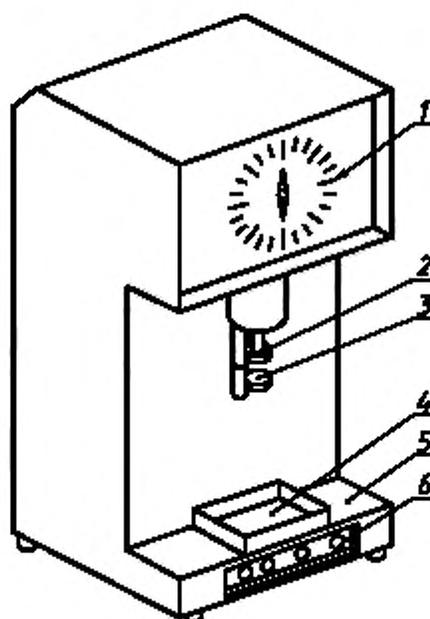
1 — шкала; 2 — лоток; 3 — предметный столик; 4 — емкость; 5 — корпус; 6 — пульт управления
