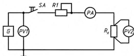
*G* — источник тока; *SA* — выключатель; *RI* — переменный резистор; *PA* — амперметр; *PV1*, *PV2* — вольтметры, *R<sub>x</sub>* — сопротивление измеряемого контакта
