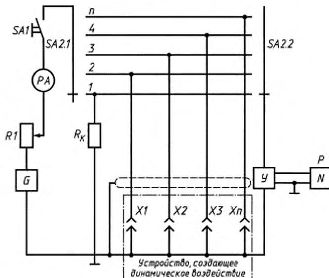
$G$  — источник тока;  $SA1$ ,  $SA2$  — переключатели;  $PA$  — амперметр;  $R1$  — переменный резистор;  $R_k$  — калибровочный резистор;  $Y$  — усилитель;  $P$  — осциллограф;  $X1$ ,  $X2$ ,  $X3$ , ...,  $Xn$  — измеряемые контакты; 1, 2, 3, 4, ...,  $n$  — положения измеряемых контактов
