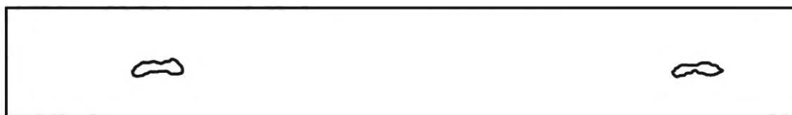
*b* — пример 2: два несовершенства размером 6,0 мм
