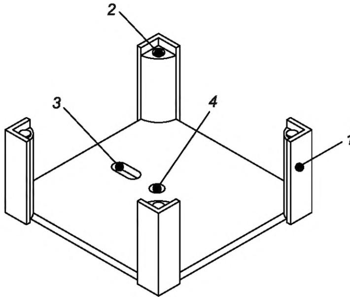
Примечание — Опорная конструкция для гнездовой кассеты состоит из рамки с четырьмя стойками, удерживающими кассету в четырех углах. Съемная средняя стойка используется для удержания кассеты в плоском состоянии. Отверстие посередине служит для размещения съемной средней стойки.
