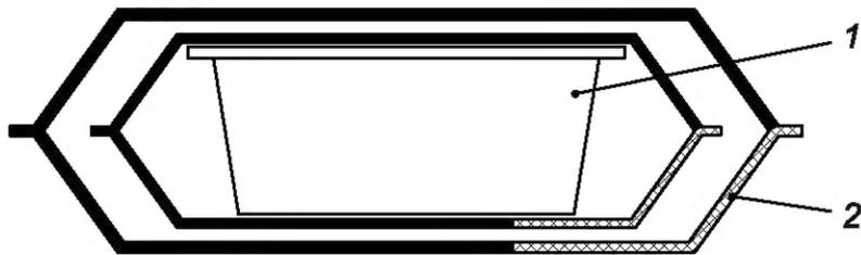
Примечание — Окошки самогерметизирующегося пакета или пакета в рулоне расположены друг над другом, чтобы обеспечить достаточную проницаемость для стерилизующих газов и воздуха.
