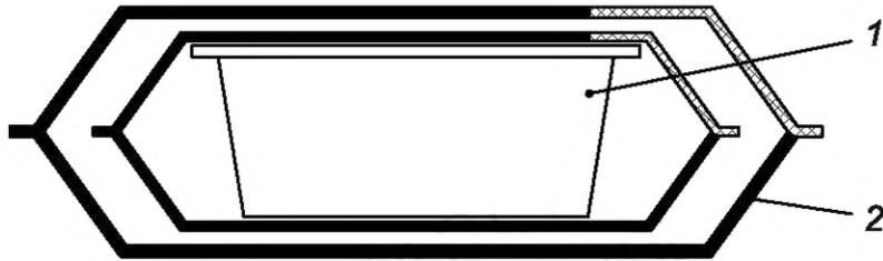
Примечание — Окна двойного самогерметизирующегося пакета или пакета в рулоне расположены наверху друг над другом для обеспечения достаточной проницаемости для стерилизующих газов и воздуха.
