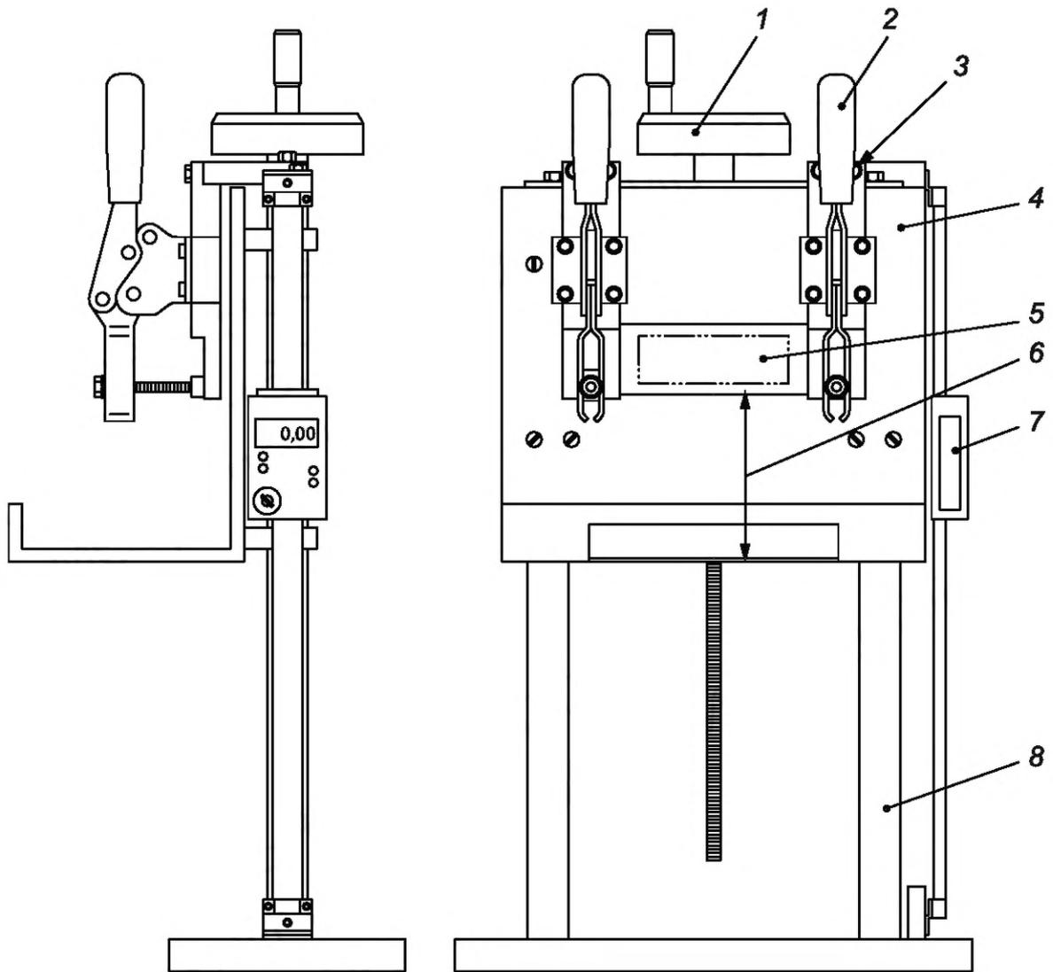
1 — вращающаяся рукоятка; 2 — изогнутый зажимной рычаг; 3 — регулируемые изогнутые зажимные рычаги для лотков разной высоты; 4 — смещение (например, 120 мм); 5 — зона термосварки; 6 — подвижная пластина; 7 — измерительное устройство; 8 — опорная стойка
