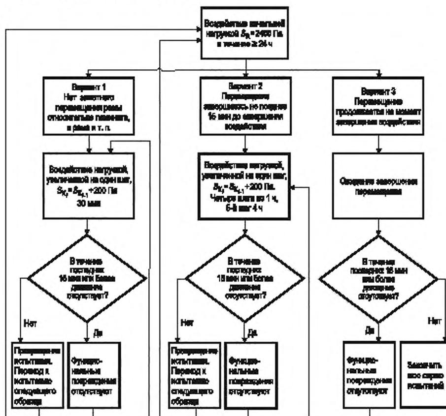
Рисунок 4 — Порядок проведения испытания на воздействие неравномерной статической механической нагрузки при испытаниях по последовательности А
