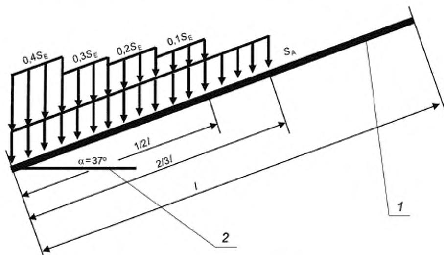
1 — испытуемый образец; 2 — горизонтальная плоскость
