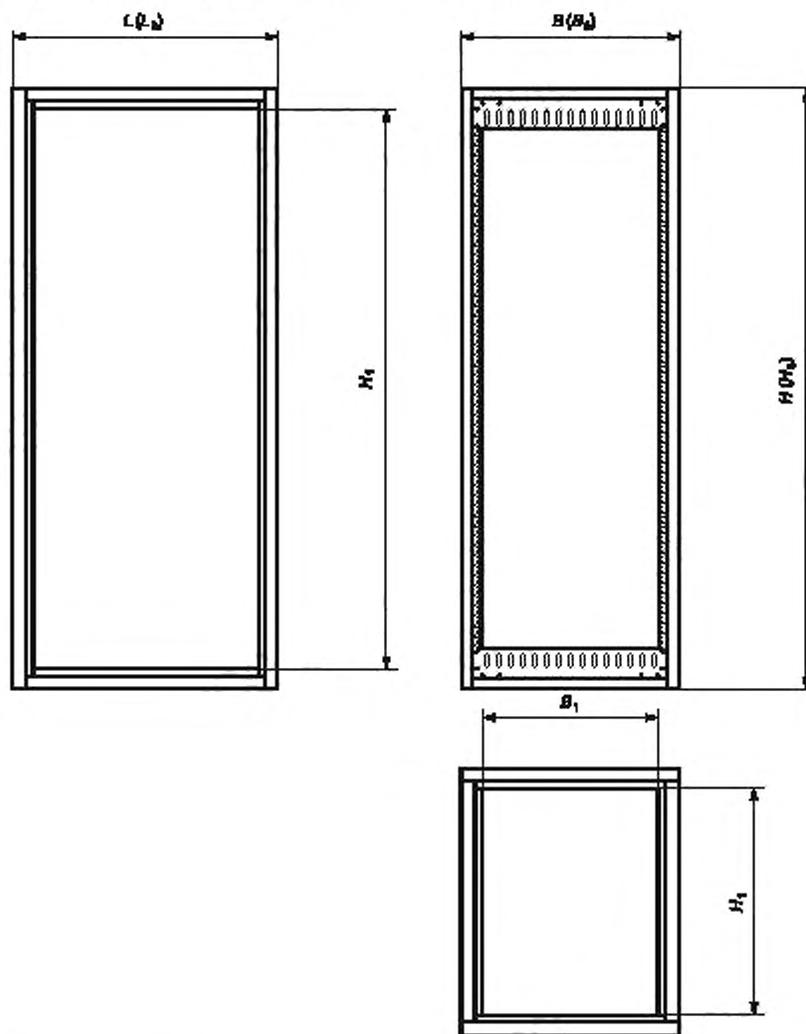
$H_0$ ,  $B_0$ ,  $L_0$  — наружные размеры БНКЗ по высоте, ширине и глубине соответственно,  $H_1$ ,  $B_1$ ,  $L_1$  — установочные размеры БНКЗ по высоте, ширине и глубине, т. е. размеры проема БНКЗ под установку БНК2 и (или) БНК1;  $H$ ,  $B$ ,  $L$  — координационные размеры БНКЗ по ГОСТ Р 51623
