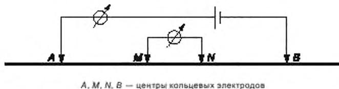
Рисунок А.2 — Электрическая (симметричная четырехэлектродная) схема электрокаротажного модуля зонда
