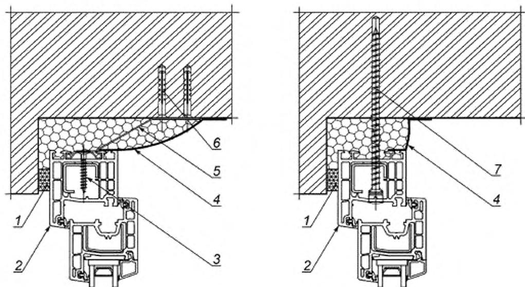
1 — гидроизоляционный слой; 2 — оконный блок; 3 — саморез; 4 — пароизоляционный слой;
