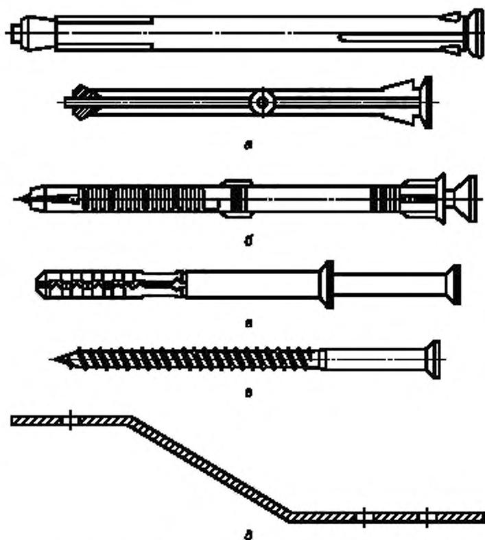
а – металлический рамный дюбель; б – пластмассовый рамный дюбель, в – универсальный пластмассовый дюбель со стопорным шурупом, г – строительные шурупы, д – гибкая анкерная пластина
