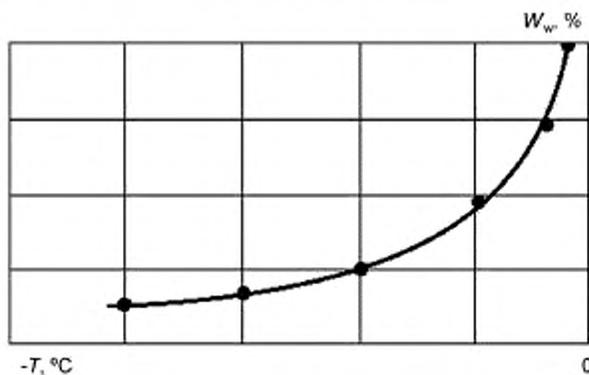
Рисунок А.1 — График зависимости влажности грунта за счет незамерзшей воды от температуры W<sub>w</sub>(-T, °C), %
