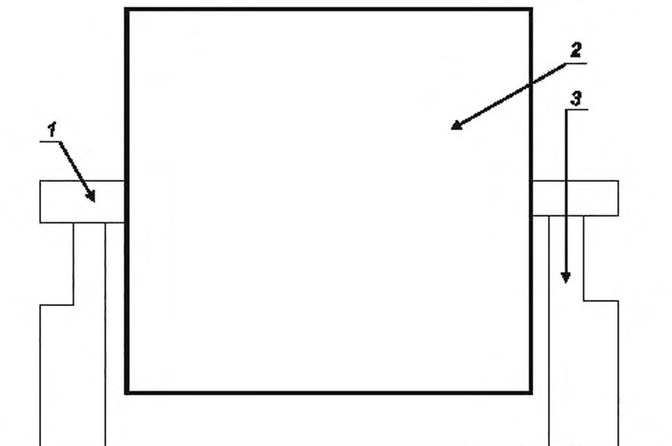
1 — вал, 2 — обечайка барабана; 3 — стойки стэнда
