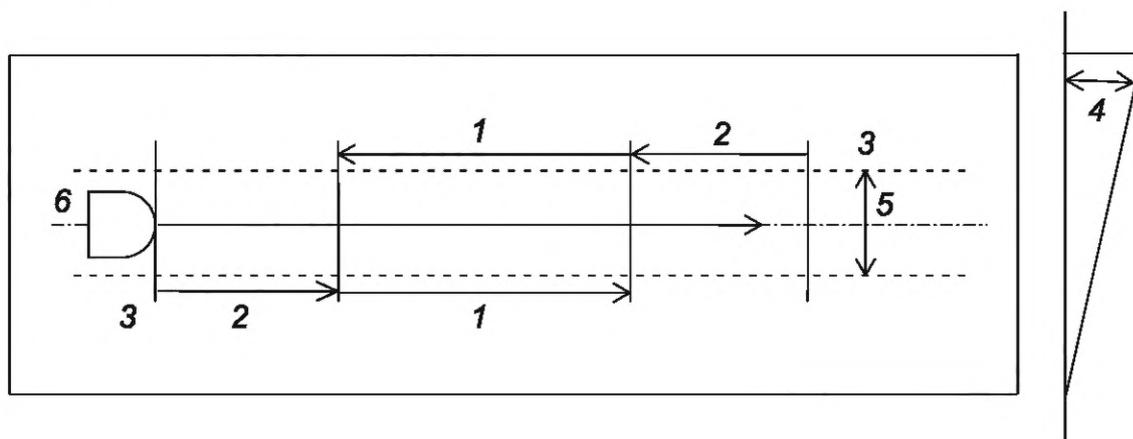
1 — зона наблюдения; 2 — зона ускорения; 3 — исходная позиция; 4 — угол наклона поверхности; 5 — допустимая ширина; 6 — робот
