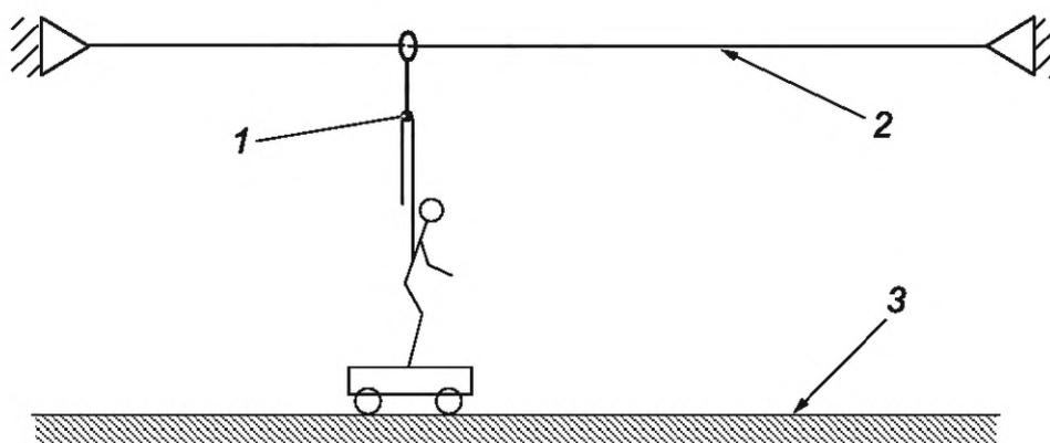
1 — подвижное устройство; 2 — направляющая штанга; 3 — поверхность испытательной дорожки
