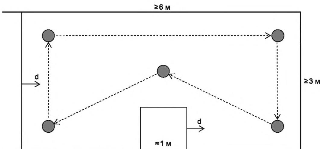
Рисунок 24 — Оборудование и маршрут перемещения для испытания локализации
