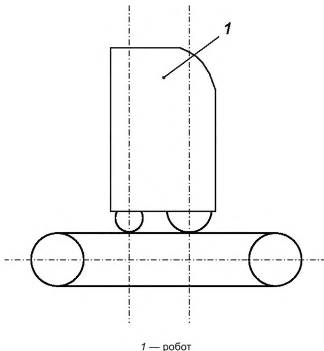
Рисунок 9 — Испытательная машина типа бегущей дорожки
