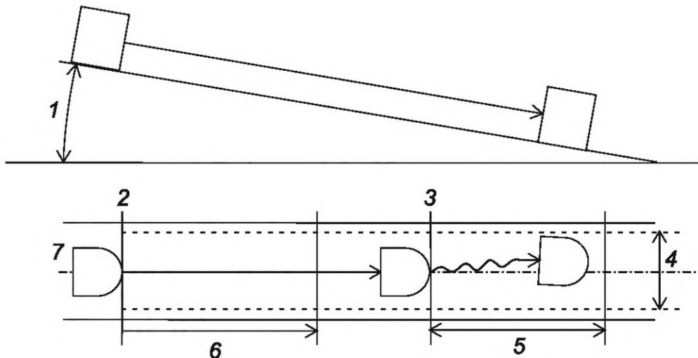
1 — угол наклона поверхности; 2 — исходная позиция; 3 — позиция начала торможения; 4 — допустимая ширина; 5 — допустимое расстояние торможения; 6 — зона ускорения; 7 — робот
