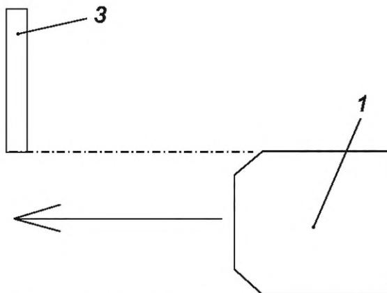
б) Левый край образца для испытаний совпадает с правым краем робота
