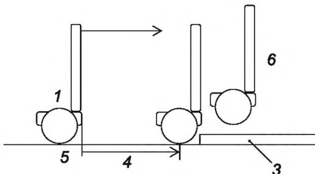
с) Ускорение колеса без контакта с поверхностью
