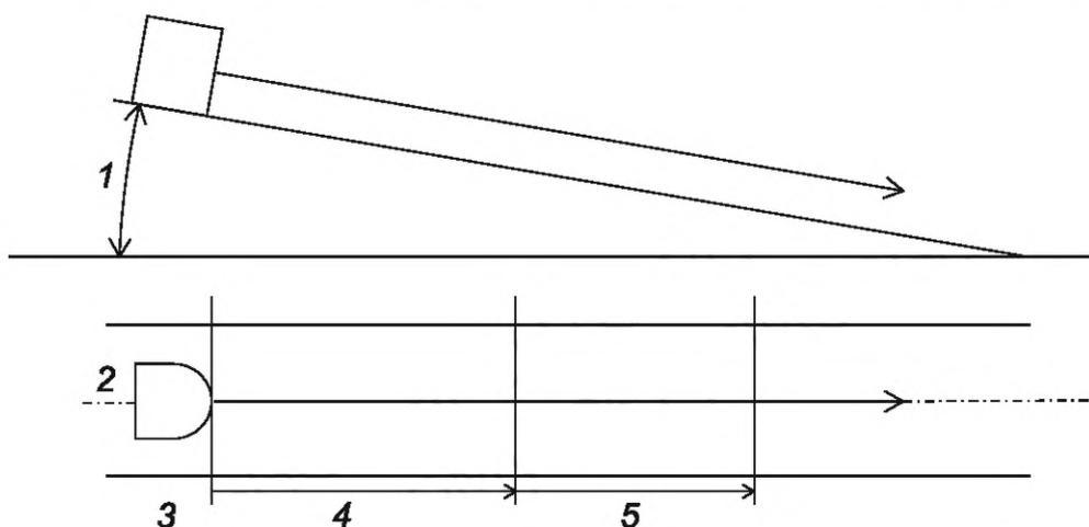
1 — угол наклона поверхности; 2 — робот; 3 — исходная позиция; 4 — зона ускорения; 5 — зона измерения скорости
