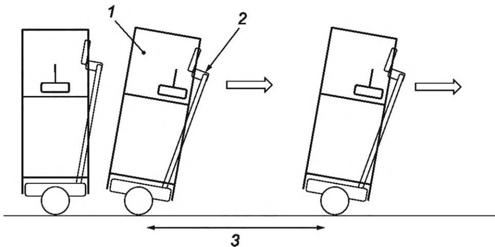
1 — модель; 2 — робот для перевозки человека; 3 — зона ускорения
