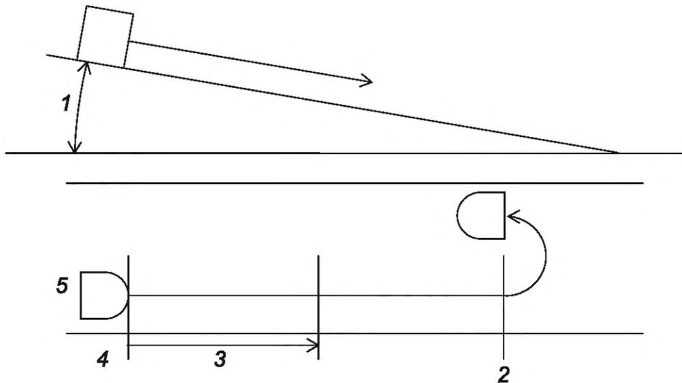
1 — угол наклона поверхности; 2 — позиция разворота; 3 — зона ускорения; 4 — исходная позиция; 5 — робот
