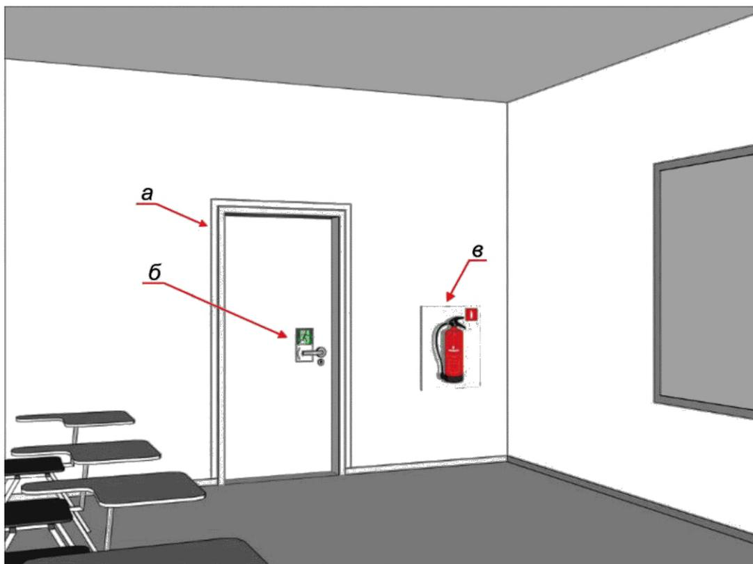
а — обозначение контура двери фотолюминесцентной полосой; б — обозначение механизма двери; в — пример обозначения места размещения огнетушителя при помощи светового экрана
