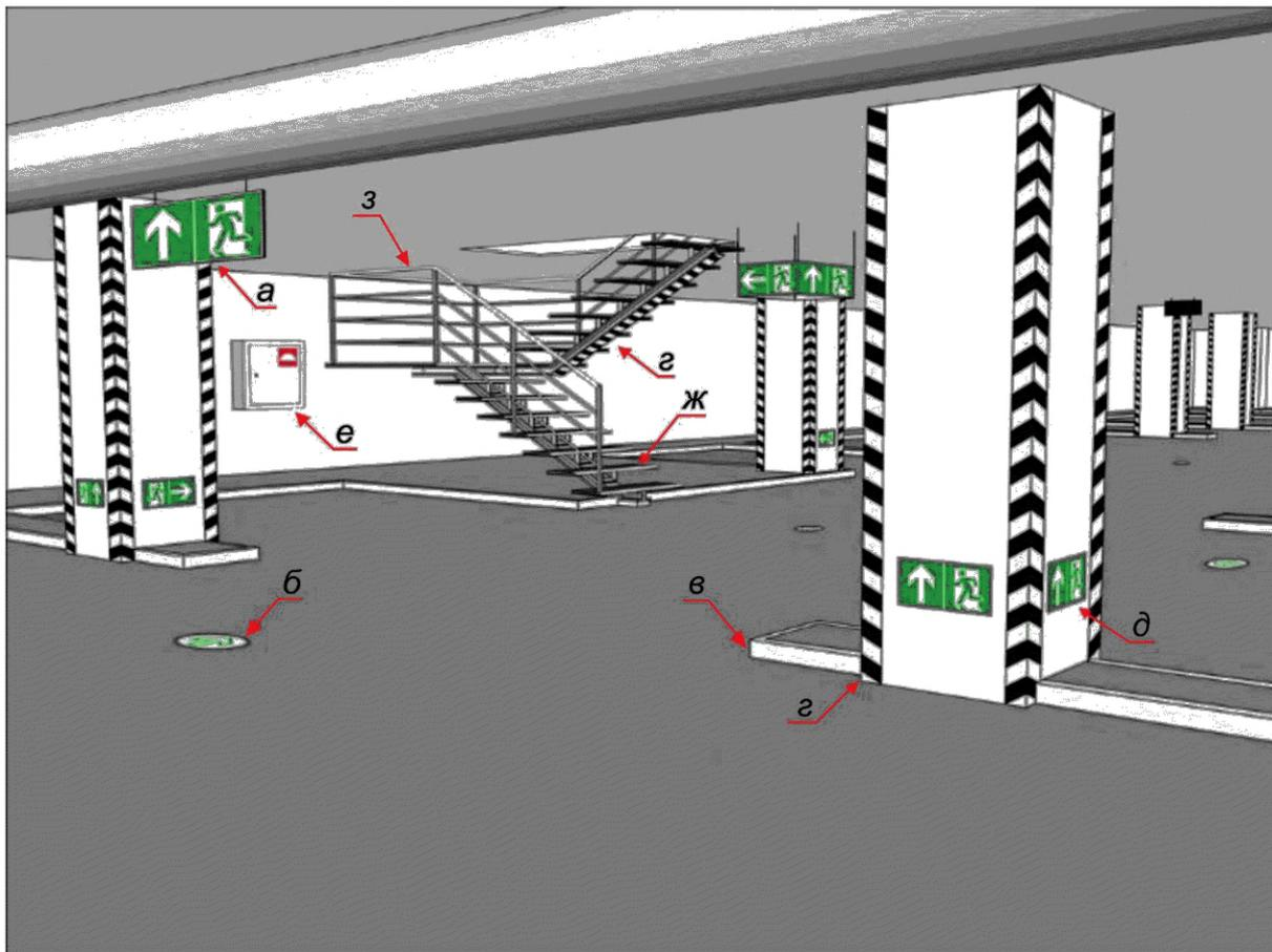
а — подвесной комбинированный указатель направления эвакуации; б — напольный указатель направления эвакуации; в — обозначение препятствий (перепадов пола); г — обозначение опасной зоны или конструкции здания, которая может стать причиной травмы; д — низко расположенный указатель направления эвакуации; е — обозначение места размещения пожарного оборудования; ж, з — обозначение ступеней и перил лестниц
