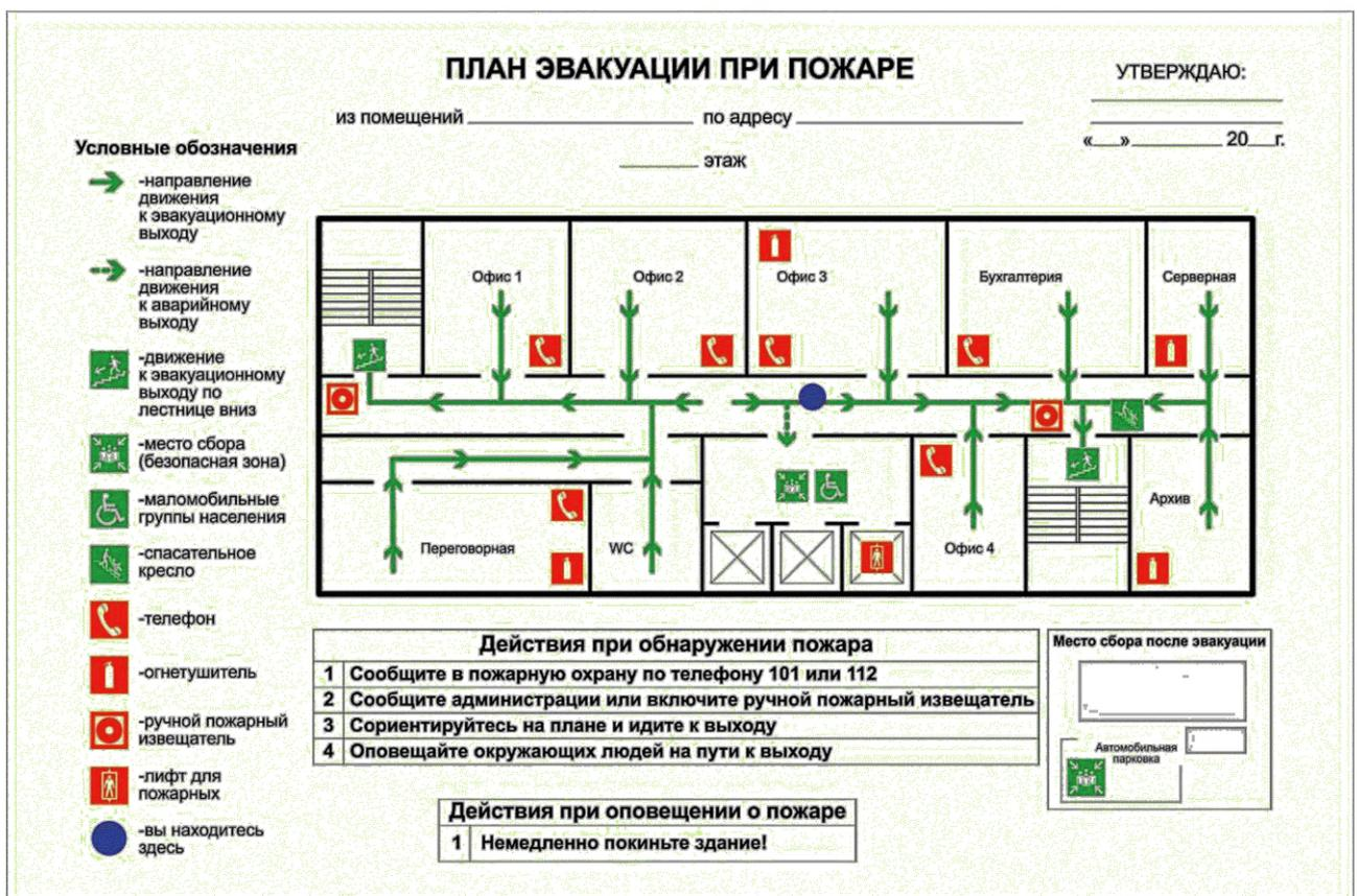
Рисунок 9 — Пример плана эвакуации
