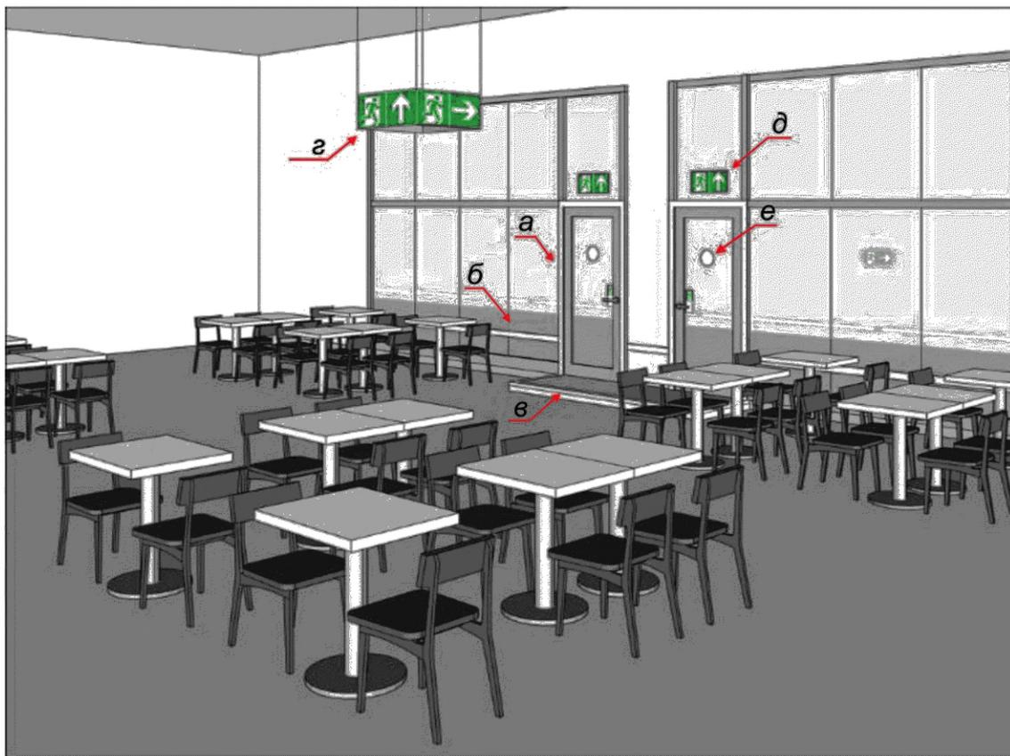
а — обозначение контура и механизма двери; б — обозначение стеклянной перегородки фотолюминесцентной полосой шириной не менее 50 мм; в — обозначение препятствий (ступенек) на полу; г — подвесной указатель направления эвакуации; д — указатель направления эвакуации («Продолжать движение через эту дверь»), размещенный над выходом; е — обозначение стеклянных дверей фотолюминесцентными элементами круглой формы
