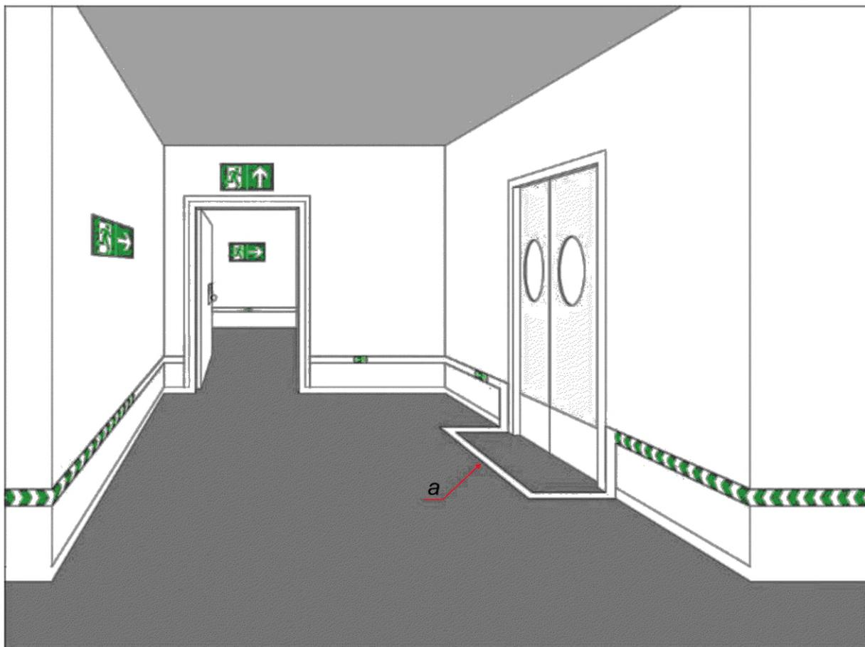
*a* — обозначение геометрии безопасного эвакуационного пути напольной фотолюминесцентной полосой
