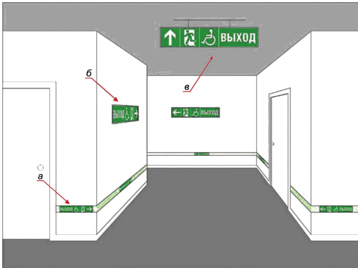
*a* — низко расположенная настенная направляющая линия с включенным в ее состав указателем направления эвакуации;
