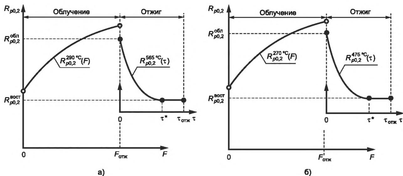
Рисунок Н.1 — Схема изменения предела текучести  $R_{p0,2}$  материала КР ВВЭР-1000 а) и КР ВВЭР-440 б) при облучении и отжиге
