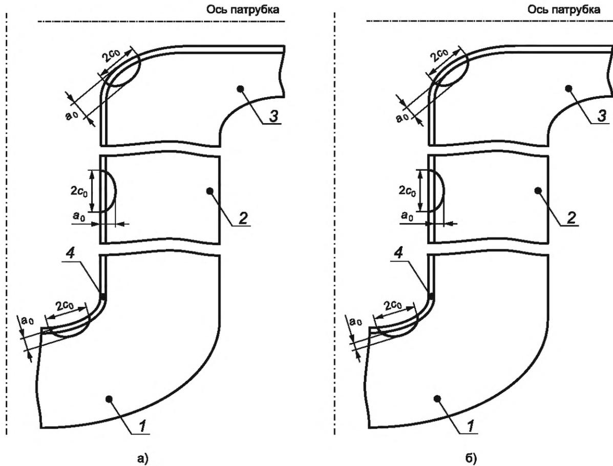
1 — днище; 2 — цилиндрическая часть КР; 3 — патрубок; 4 — антикоррозионная наплавка
