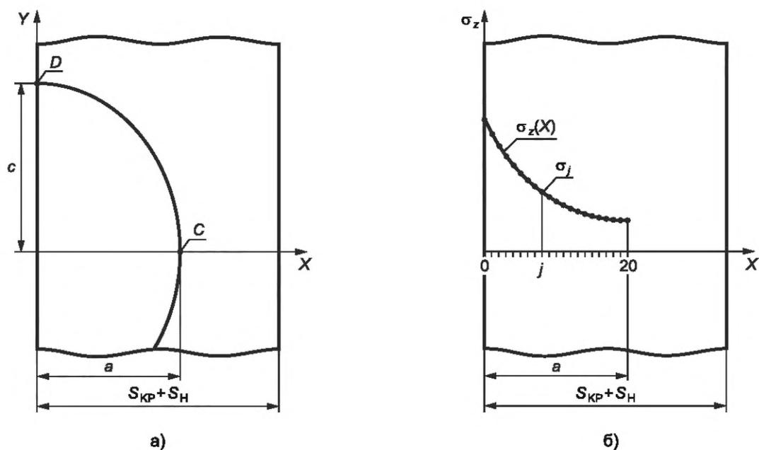
$C, D$  — расчетные точки;  $a, c$  — малая и большая полуоси расчетного дефекта;  $S_{KP}$  — толщина стенки КР без наплавки;
