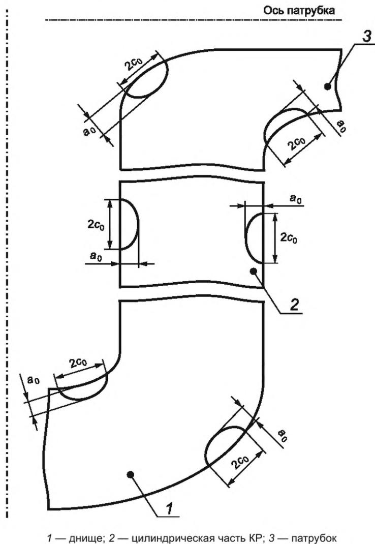
Рисунок 8.3 — Примеры расположения поверхностных расчетных дефектов в виде осевой полуэллиптической трещины в КР без антикоррозионной наплавки
