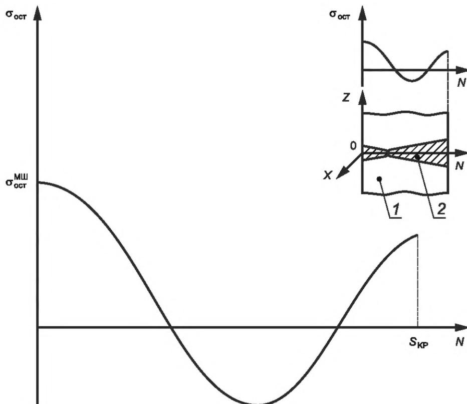
1 — основной металл; 2 — кольцевой сварной шов;  $S_{\text{КР}}$  — толщина стенки элемента КР;  $(Z, X, N)$  — локальная декартова система координат;  $N$  — нормаль к поверхности элемента КР;  $Z$  — касательная к образующей элемента КР
