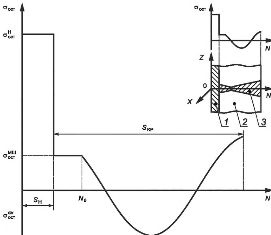
1 — антикоррозионная наплавка; 2 — основной металл; 3 — кольцевой сварной шов;  $S_H$  — толщина наплавки;  $S_{\text{КР}}$  — толщина стенки элемента КР без наплавки;  $(Z, X, N)$  — локальная декартова система координат;  $N$  — нормаль к поверхности элемента КР;  $Z$  — касательная к образующей элемента КР
