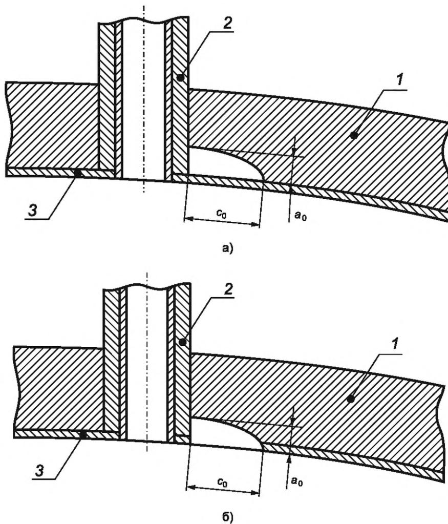
1 — крышка реактора; 2 — патрубок; 3 — антикоррозионная наплавка
