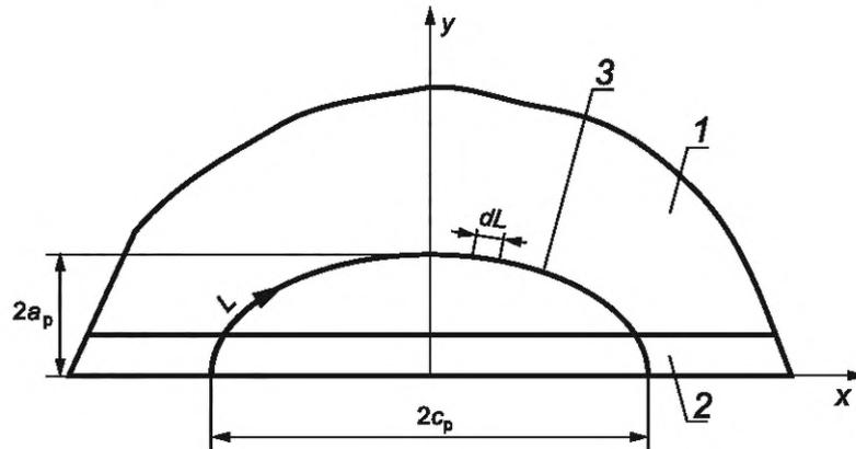
1 — основной металл или металл шва; 2 — антикоррозионная наплавка; 3 — фронт трещины
