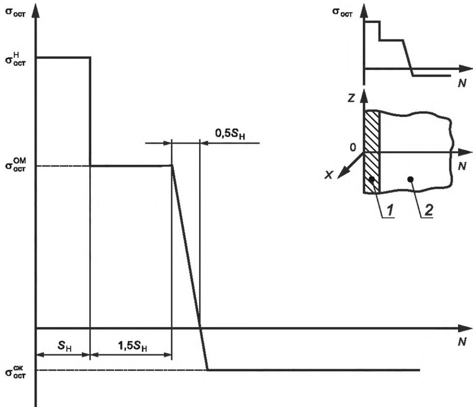
1 — антикоррозионная наплавка; 2 — основной металл;  $S_H$  — толщина наплавки;  $(Z, X, N)$  — локальная декартова система координат;  $N$  — нормаль к поверхности элемента КР;  $Z$  — касательная к образующей элемента КР
