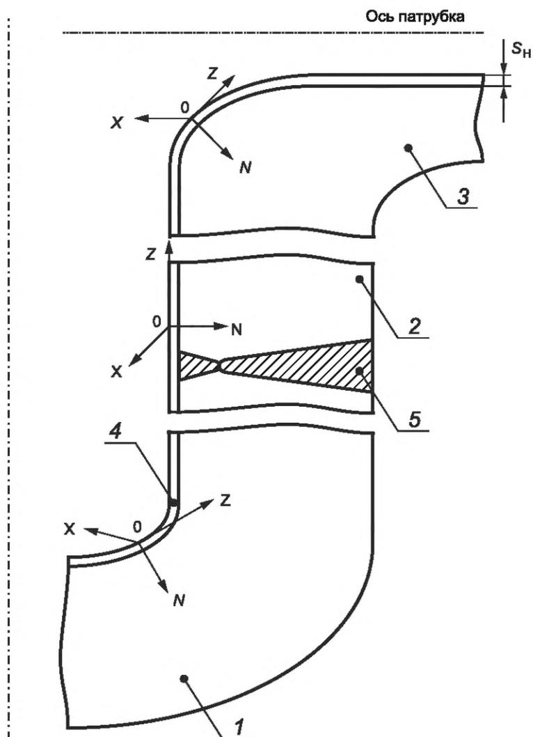
1 — дно; 2 — цилиндрическая часть КР; 3 — патрубок; 4 — антикоррозионная наплавка; 5 — кольцевой сварной шов;
