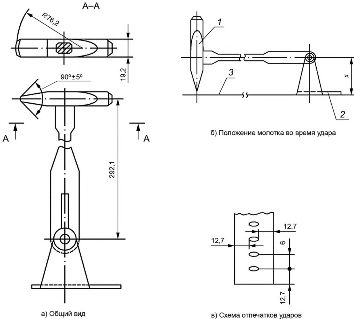
1 — молот; 2 — прижимная плита; 3 — поверхность испытываемого образца;  $x$  — размер, определяемый опытным путем в зависимости от металла, из которого изготовлена головка молотка
