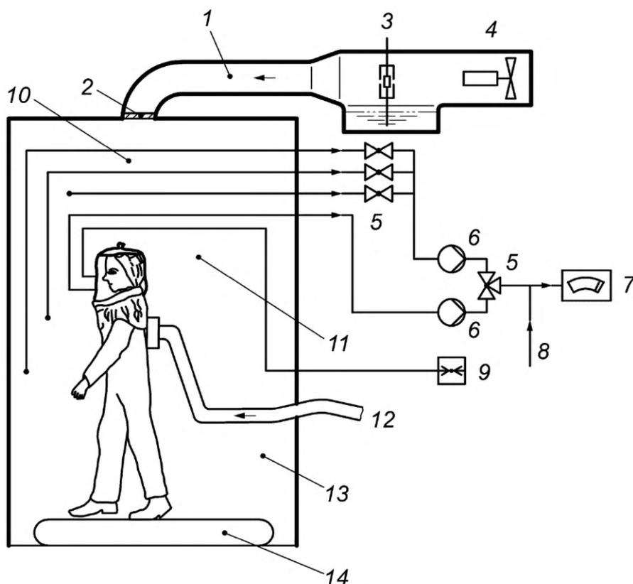
1 — трубопровод; 2 — дефлектор; 3 — распылитель; 4 — побудитель расхода воздуха; 5 — клапаны; 6 — насосы; 7 — пламенный фотометр; 8 — дополнительная подача чистого воздуха; 9 — манометр; 10 — система отбора проб из испытательной камеры; 11 — система отбора проб из зоны дыхания; 12 — подача воздуха для дыхания; 13 — испытательная камера; 14 — беговая дорожка
