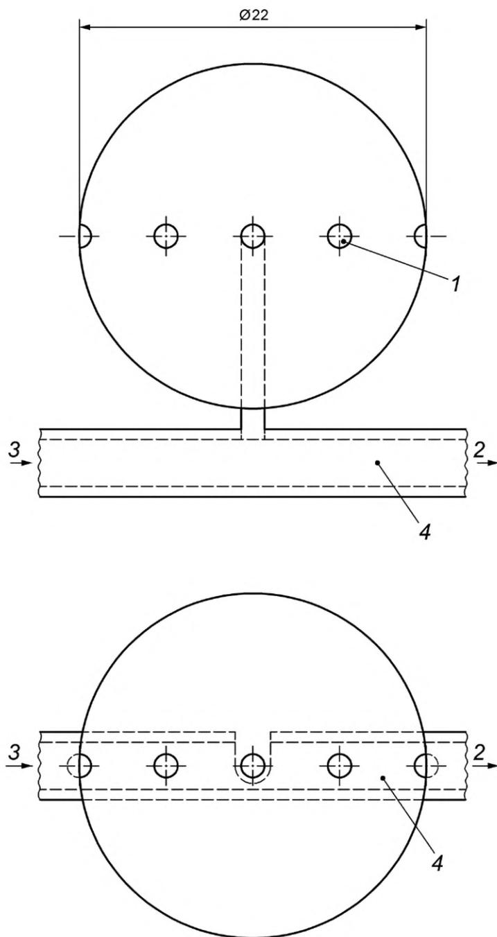
1 — восемь отверстий диаметром 1,5 мм с равными интервалами; 2 — подключение к пробоотборному насосу; 3 — направления сушки воздухом (только для аэрозоля хлорида натрия); 4 — подходящие гибкие трубки
