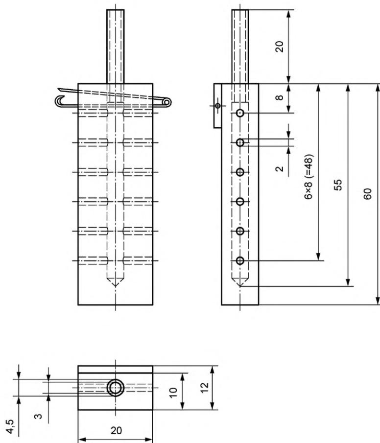
Рисунок А.2 — Пробоотборник для внутреннего пространства *специальной одежды***А.4.3 Пробоотборник для зоны дыхания**
