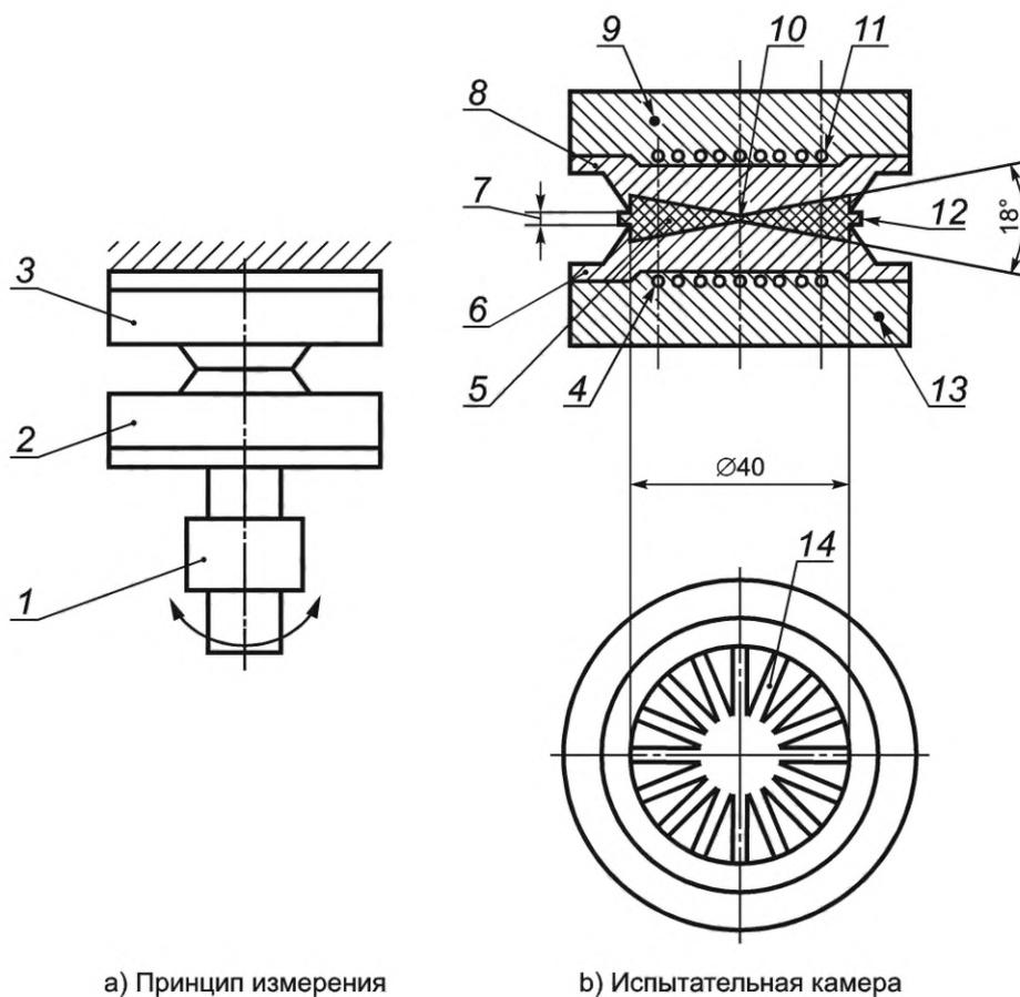
1 — система измерения крутящего момента; 2 — колеблющаяся полуформа; 3 — неподвижная полуформа; 4 — нагреватель; 5 — образец для испытания; 6 — нижняя полуформа; 7 — зазор между полуформами; 8 — верхняя полуформа; 9 — температурный датчик; 10 — зазор, равный 0,5 мм плюс зазор между полуформами; 11 — нагреватель; 12 — излишки образца; 13 — температурный датчик; 14 — канавки
