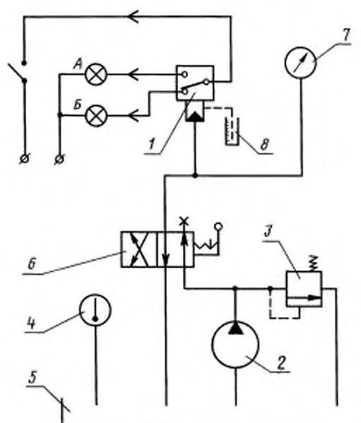
1 — испытуемое реле; 2 — насос; 3 — предохранительный клапан; 4 — термометр; 5 — бак;
