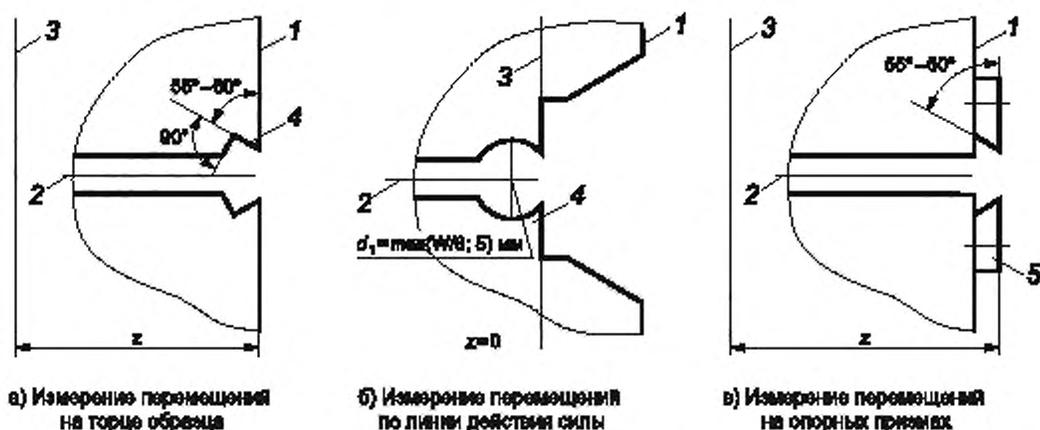
1 — передний торец образца; 2 — плоскость надреза; 3 — линия действия силы; 4 — призматический выступ; 5 — накладная опорная призма
