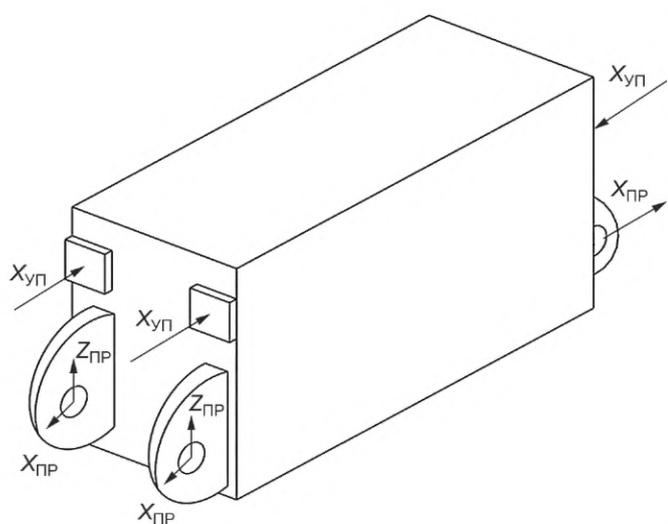
Рисунок 1 — Схема нагружения опорных узлов самонесущего груза
