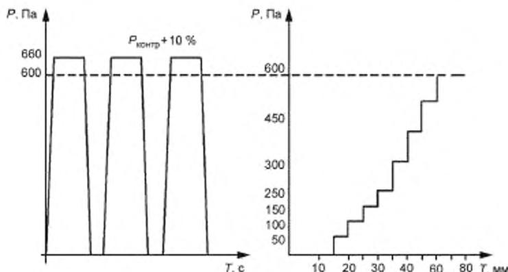
Рисунок 4 — График изменения давления на образец при испытании КФС на водонепроницаемость для конечного контрольного давления 600 Па
