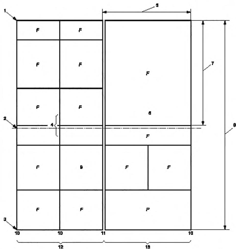
1 — соединение с верхним этажом; 2 — соединение с верхним полуэтажом; 3 — соединение с нижним этажом; 4 — шов стойки; 5 — максимальная ширина поля; 6 — наименьшая возможная глубина ригеля для получения максимального допустимого прогиба; 7 — максимальная высота поля; 8 — высота в два этажа; 9 — вставленная рама для окна; 10 — стойка; 11 — сдвоенная стойка; 12 — общий отвод воды; 13 — отвод воды, относящийся к полю
