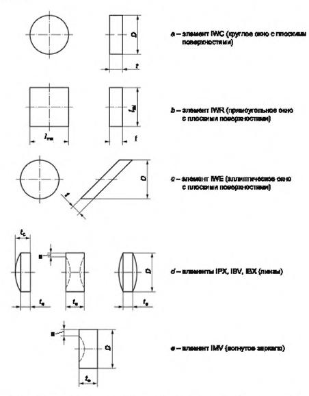
D- диаметр;  $l_{\min}=$  длина наибольшей боковой поверхности;  $l_{\min}=$  длина наименьшей боковой поверхности; t= толщина;  $t_{\mathrm{g}}=$  толщина элемента в центре,  $t_{\mathrm{g}}=$  толщина края; a= ширина кольцевого зазора (при необходимости)
