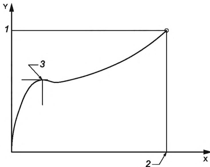
X — удлинение, E; Y — усилие; 1 — максимальное усилие; 2 — удлинение при максимальном усилии;
