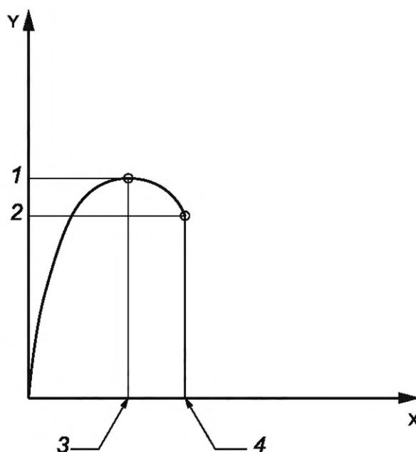
X — удлинение, E; Y — усилие; 1 — максимальное усилие; 2 — усилие при разрыве;
