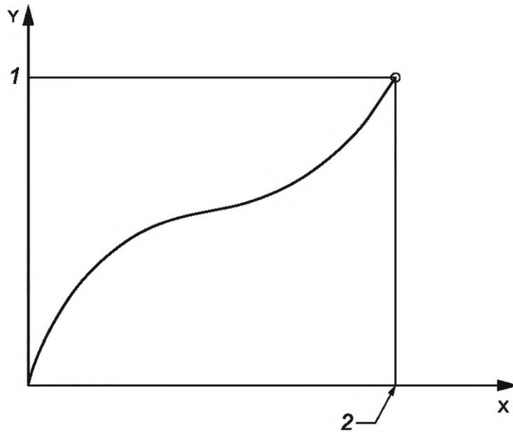
X — удлинение, E; Y — усилие; 1 — максимальное усилие; 2 — удлинение при максимальном усилии
