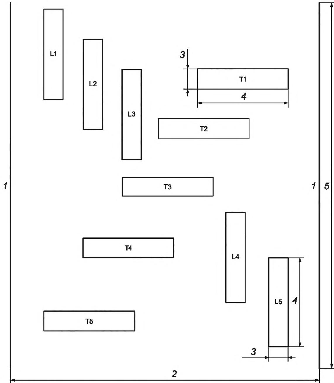
L — испытуемые пробы, вырезанные в продольном направлении; T — испытуемые пробы, вырезанные в поперечном направлении; 1 — кромка; 2 — полезная ширина; 3 — ширина; 4 — длина; 5 — примерно 1 м
