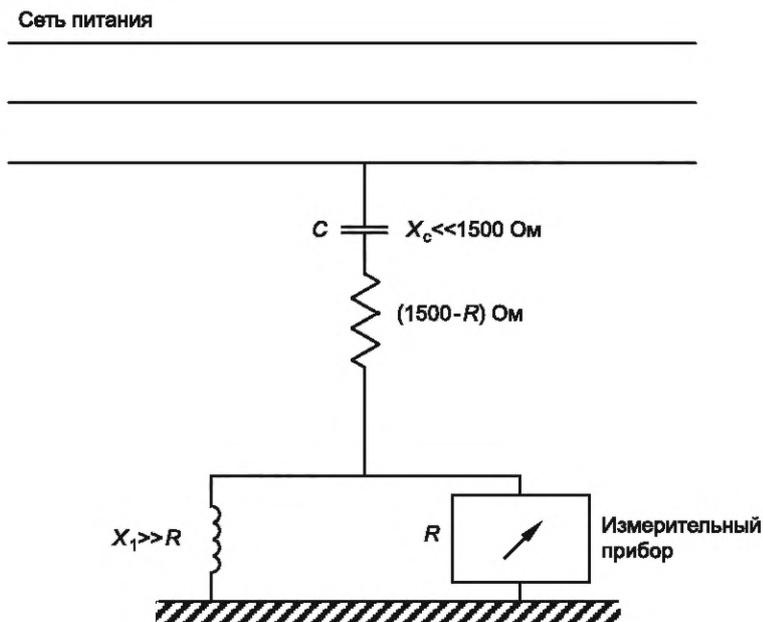
Рисунок 1 — Схема измерения напряжения помех по сетям питания
