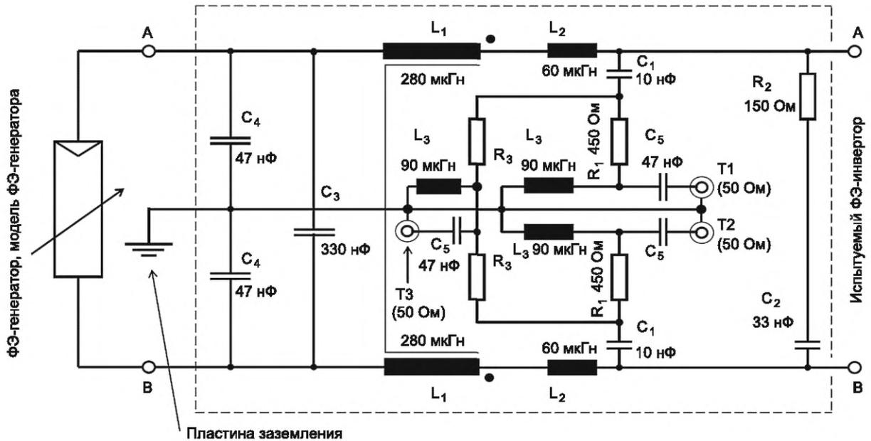
DC-AN с  $Z_{CM} = 150 \text{ Ом}$ ,  $Z_{DM} = 100 \text{ Ом}$ , T1, T2 и T3 нагрузкой 50 Ом.
