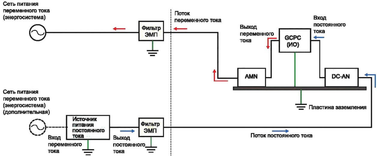
Рисунок J.5 — Схема измерительной площадки (пример 3), схема 2D
