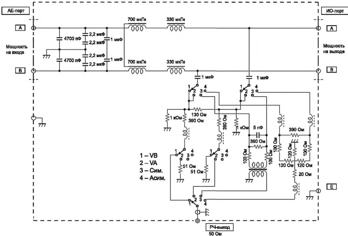
Примечание — Режимы 1 и 2 отображают применение эквивалента сети в качестве псевдо-V-образного эквивалента сети, т. е. для измерения несимметричных напряжений помех или напряжений помех на зажимах. При использовании в качестве псевдо-V-образного эквивалента сети, т. е. в режиме 1 или 2 согласованная нагрузка дифференциального режима составляет 100 Ом. При использовании дельтообразного эквивалента сети, т. е. в режиме 3 или 4, согласованное напряжение дифференциального режима составляет 150 Ом.
