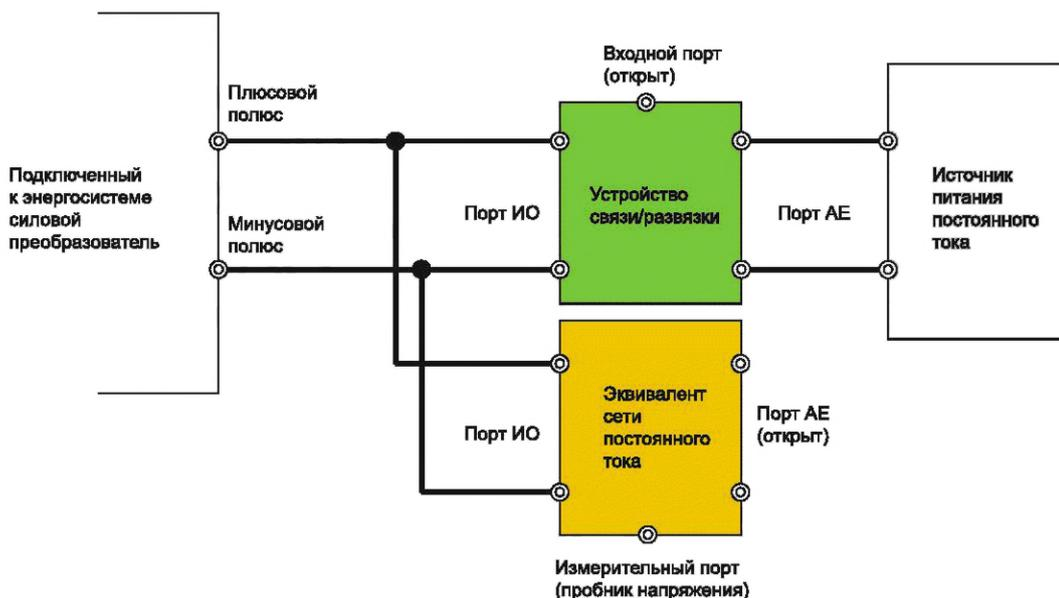
Рисунок 7 — Типовая установка для измерения кондуктивных помех на низковольтных портах электропитания постоянного тока с эквивалентом сети постоянного тока (DC-AN), используемым в качестве окончного устройства и пробника напряжения
