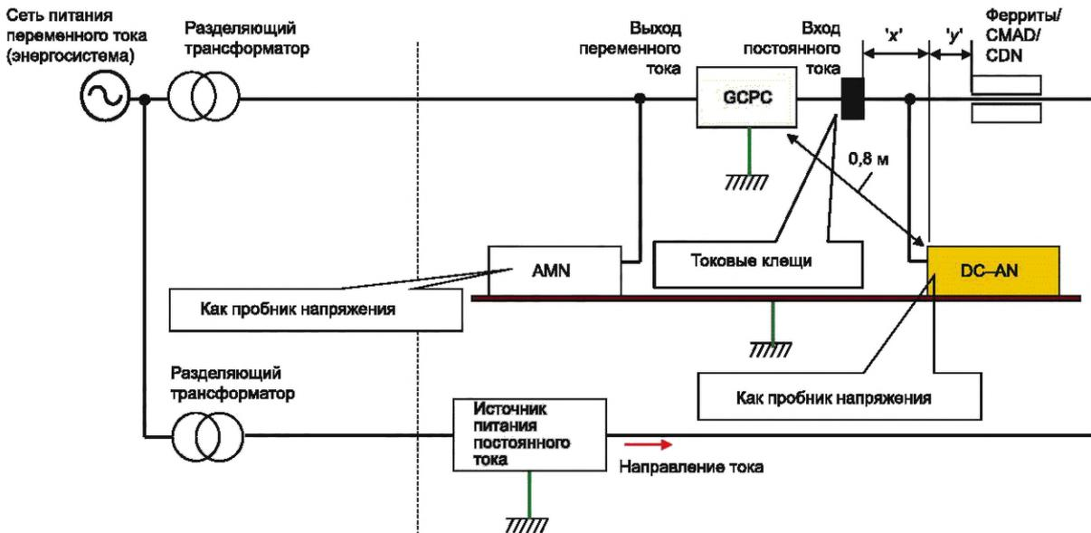
Примечание — 'x' и 'y' обозначают расстояние между пробником тока и DC-AN, DC-AN и ферритовыми трубками/CMAD/CDN соответственно. Расстояние  $x \leq 0,3$  м и  $y = 0,1$  м.
