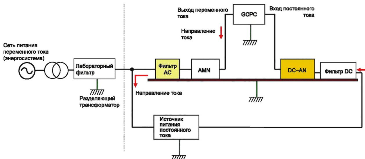
Рисунок 6 — Типовая установка для измерения кондуктивных помех на низковольтных портах электропитания постоянного тока с эквивалентом сети постоянного тока (DC-AN), используемым в качестве оконечного устройства и развязывающего блока к лабораторному источнику питания постоянного тока
