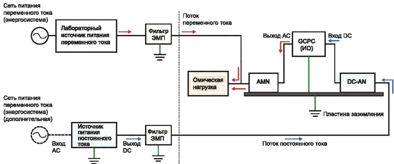
Рисунок Ж.3 — Схема измерительной площадки (пример 2), схема 2D
