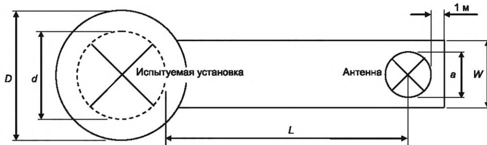
$D = (d + 2)$  м, где  $d$  — максимальный размер испытываемой установки, м;
