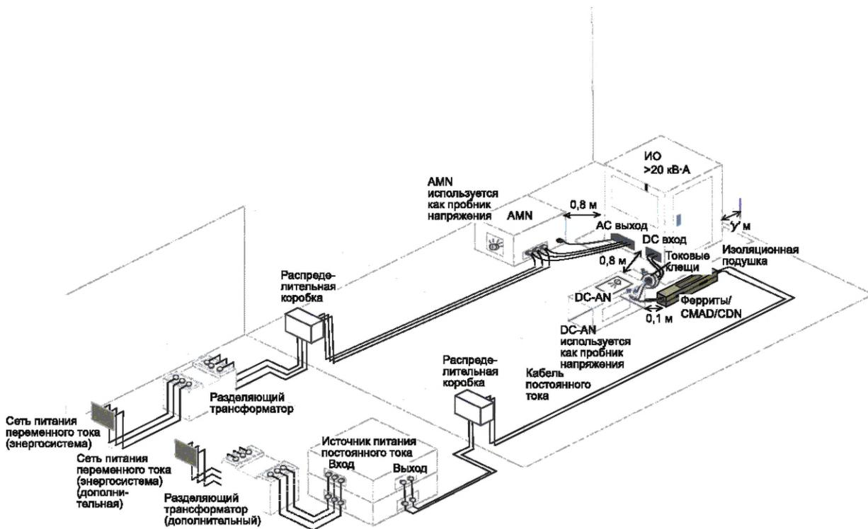
Рисунок 9 — Типовая установка для измерения кондуктивных помех на низковольтных портах электропитания постоянного тока с эквивалентом сети постоянного тока (DC-AN), используемым в качестве пробника напряжения и токовых клещей; изометрическая проекция
