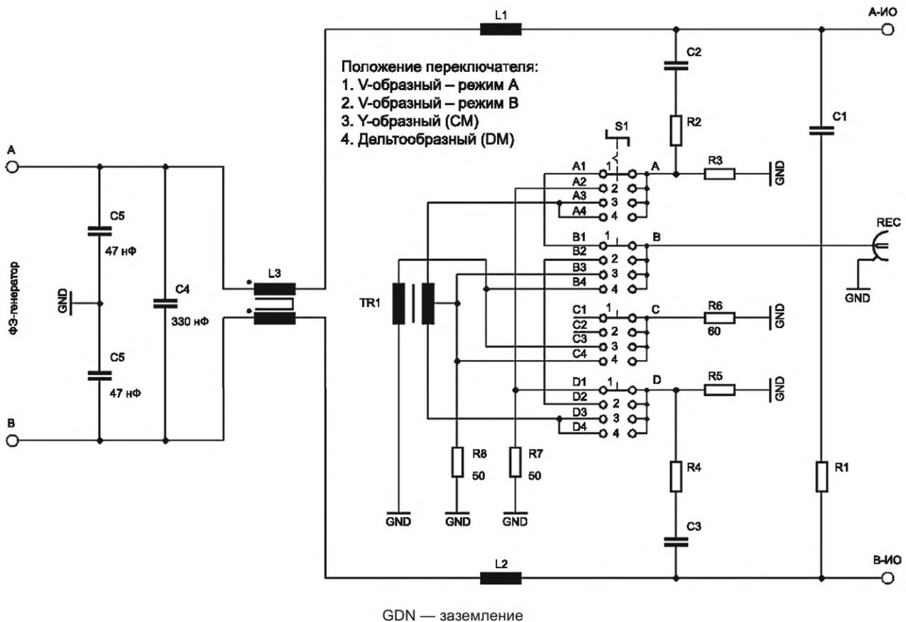
Примечание — Режимы 1 и 2 отображают применение эквивалента сети для измерения напряжений помех несимметричного режима (UM) или зажима.
