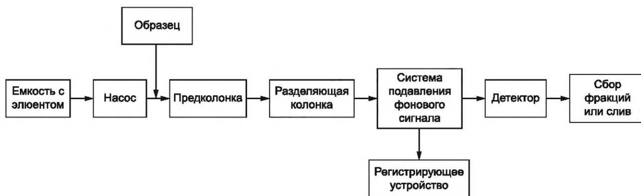
Рисунок 6 — Схема ионного хроматографа
