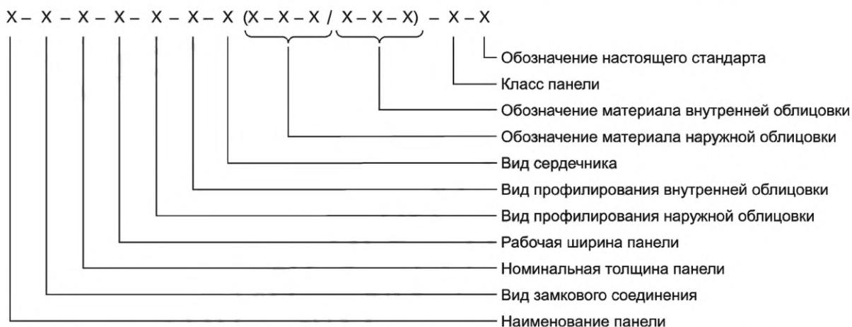
Пример условного обозначения трехслойной сэндвич-панели (ТСП), с замком (Z), условной толщиной 120 мм, рабочей шириной 1000 мм, с наружной облицовкой волна (В), с внутренней облицовкой трапеция (Т), с сердечником из минеральной ваты (МВ) с наружной облицовкой: покрытие — полиэстер (ПЭ), цвет — [RAL 5005 (синий)], толщина металла — 0,5 мм; с внутренней облицовкой: покрытие — полиэстер (ПЭ), цвет — [RAL 9003 (белый)] и толщина металла — 0,5 мм, 1-го класса, по ГОСТ 32603—2021:
