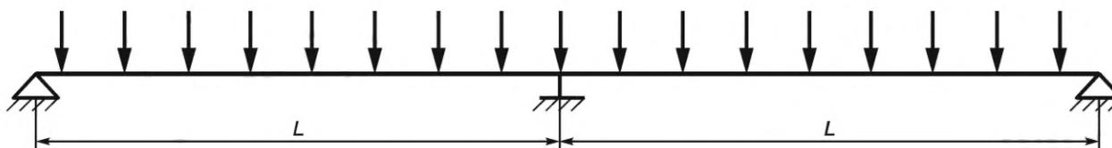
Рисунок В.3 — Расчетная схема нагружения двухпролетной панели
