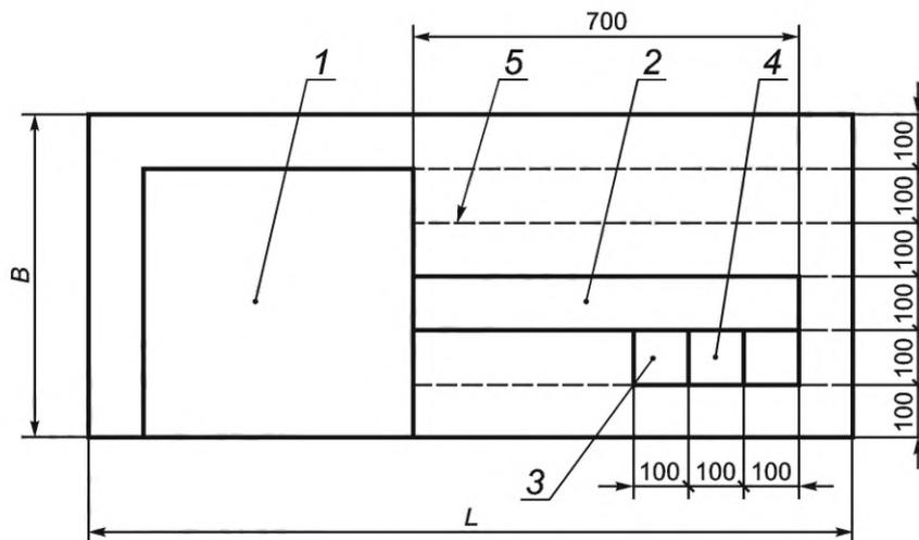
1 — образец для испытаний на плотность (размерами 500 × 500 × 100 мм); 2 — образец для испытаний на сдвиг (размерами 700 × 100 × 100 мм); 3 — образец для испытаний на сжатие (размерами 100 × 100 × 100 мм); 4 — образец для испытаний на разрыв (размерами 100 × 100 × 100 мм); 5 — линии распила плиты на ламели
