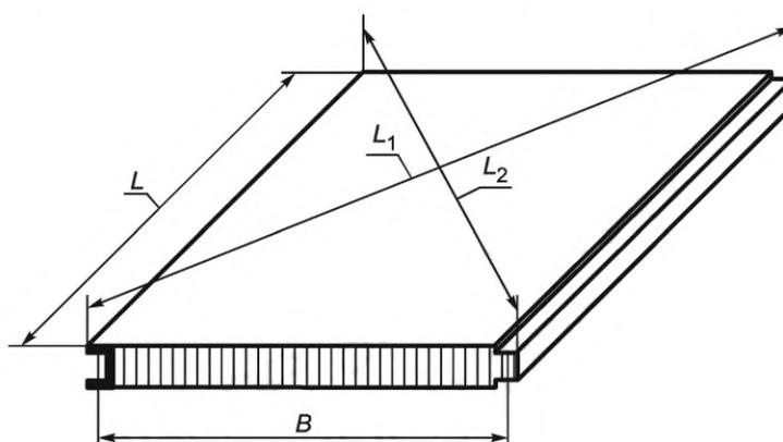
Рисунок 18 — Схема измерения косины реза панели
