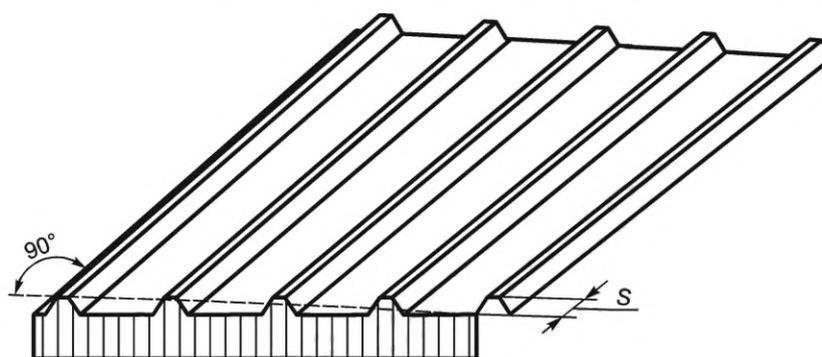
Рисунок 19 — Схема измерения отклонения от прямоугольности торцов
