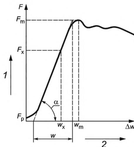
1 — нагрузка; 2 — деформация;  $\tau_c$  — разрушающее касательное напряжение образца ламели при срезе, Н/мм<sup>2</sup>;  $G_0$  — модуль сдвига образца ламели при срезе, Н/мм<sup>2</sup>;  $F_m$  — усилие при разрушении образца, Н;  $F_x$  — значение силы, соответствующее линейной деформации, Н;  $w_x$  — линейная деформация, мм;  $h$  — высота образца, равная  $(100 \pm 1)$  мм;  $B$  — ширина образца, равная  $(100 \pm 1)$  мм
