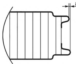
Рисунок 22 — Схема измерения смещения продольных кромок
