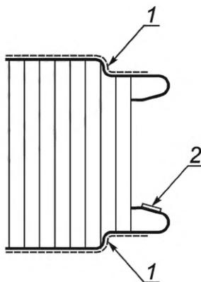
1 — защитная пленка; 2 — место нанесения маркировки
