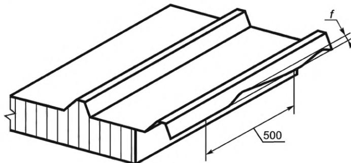
Рисунок 24 — Схема измерения отклонения кромки свободного гофра стыка
