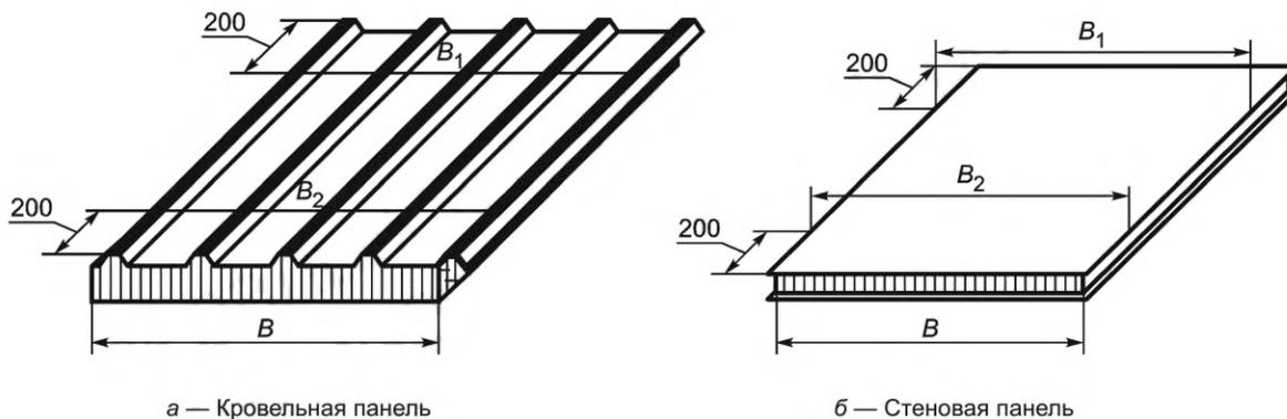
Рисунок 16 — Схема измерения рабочей ширины панели
