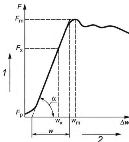
1 — нагрузка; 2 — деформация;  $F_p$  — сила, соответствующая предварительному нагружению;  $F_x$  — текущее значение силы, соответствующее линейной деформации;  $F_m$  — максимальная сила при разрушении;  $w_x$  — линейная деформация образца;  $w_m$  — деформация образца при действии максимальной силы;  $w$  — условная деформация образца при действии максимальной силы;  $\alpha$  — угол наклона условного прямолинейного участка диаграммы
