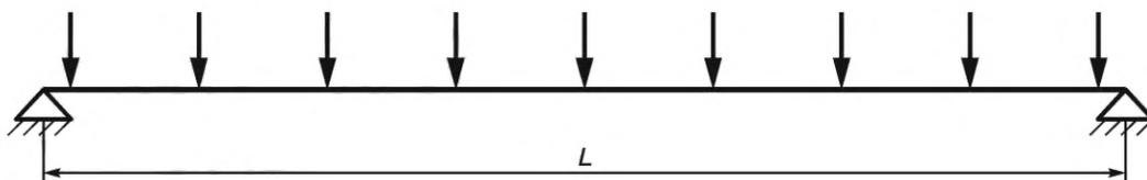
Рисунок В.1 — Расчетная схема нагружения однопролетной панели
