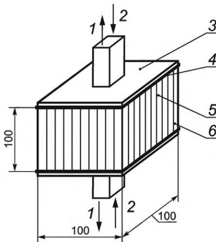
1 — испытание на растяжение; 2 — испытание на сжатие; 3 — жесткая пластина; 4 — клеевой слой; 5 — расположение волокон; 6 — образец, вырезанный из плиты
