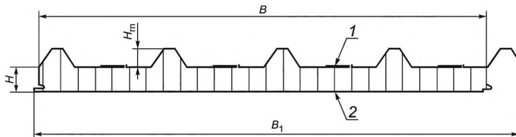
1 — наружная облицовка; 2 — внутренняя облицовка; B — рабочая ширина панели; B<sub>1</sub> — полная ширина панели; H — номинальная толщина панели; H<sub>гп</sub> — высота глубоко профилированной облицовки
