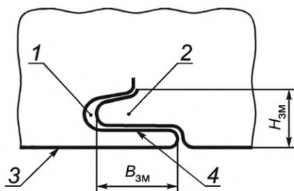
1 — паз; 2 — гребень; 3 — облицовка панели; 4 — стенка паза;  $B_{зм}$  — ширина замка (максимальный размер перехлеста гребня и стенки паза);  $H_{зм}$  — высота замка (максимальный размер перехлеста гребня и паза)
