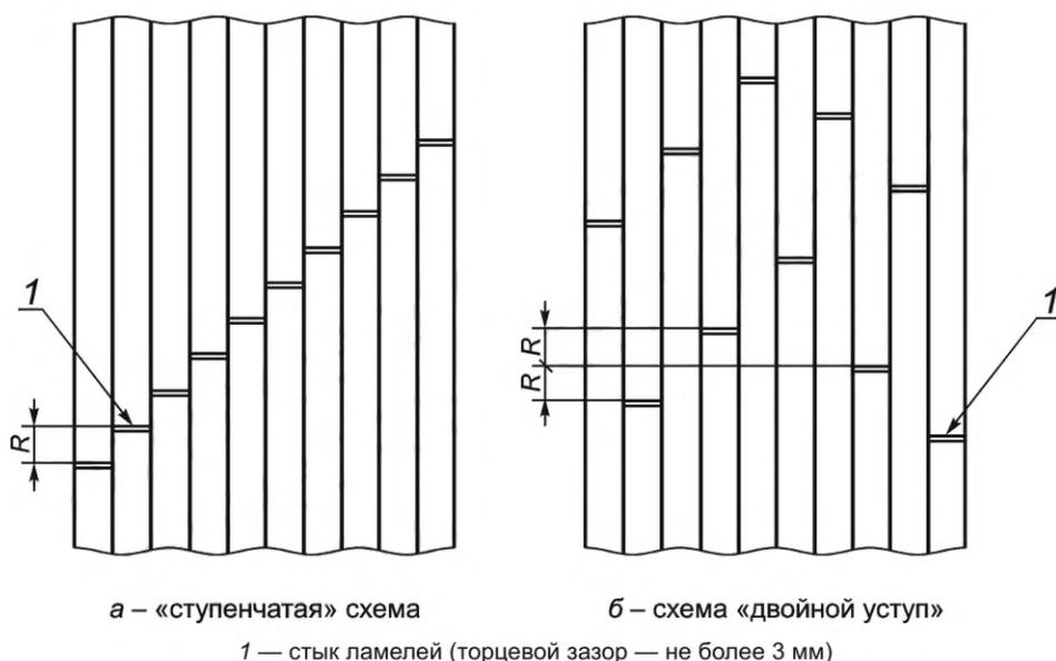
Рисунок 7 — Схемы укладки ламелей при сборке панелей
