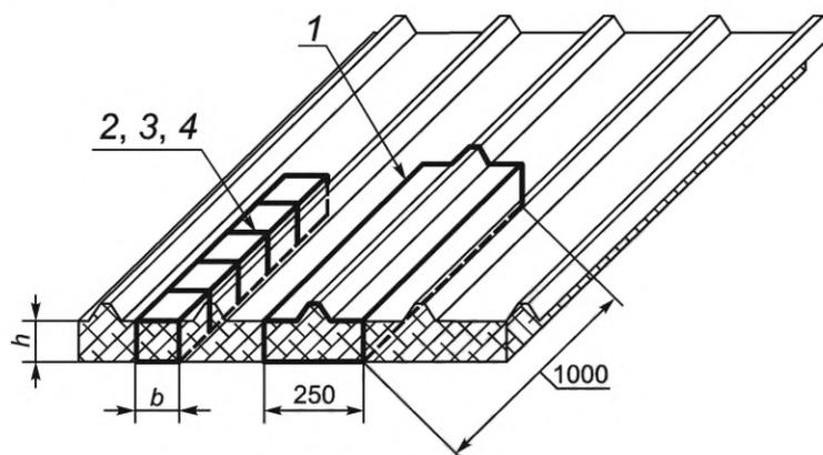
1 — зона вырезки образца для испытаний прочности на поперечный изгиб; 2 — зона вырезки образца для испытаний прочности на сжатие; 3 — зона вырезки образца для испытания прочности на растяжение; 4 — зона вырезки образца для определения физических свойств сердечника (объемная масса, влаго- и водопоглощение, теплопроводность и др.)
