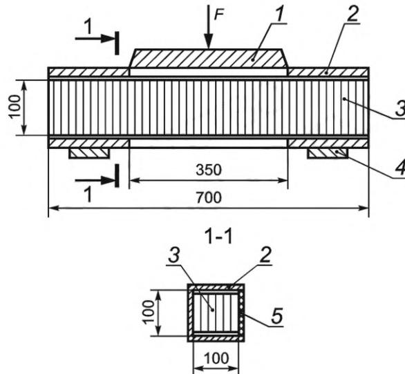
1 — режущая пластина; 2 — держатель образца; 3 — образец; 4 — опора; 5 — замыкающая пластина
