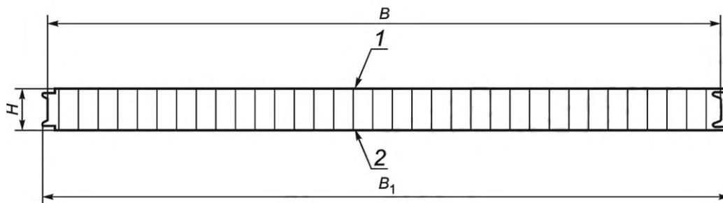
1 — наружная облицовка; 2 — внутренняя облицовка;  $B$  — рабочая ширина панели;  $B_1$  — полная ширина панели;
