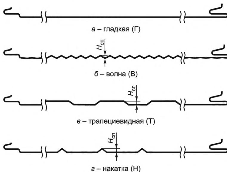
Рисунок 4 — Слабопрофилированные облицовки
