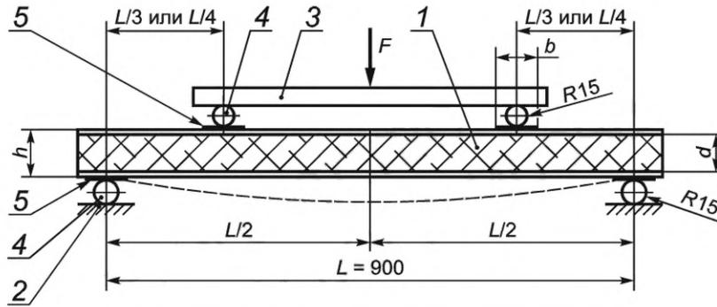
1 — испытуемый образец; 2 — опорная поверхность; 3 — распределительная балка; 4 — стальные цилиндрические опоры,  $R = 15$  мм; 5 — прокладки, одна из которых стальная сечением  $5 \times 60 \times b$  мм, другая — деревянная или фанерная сечением  $15 \times 60 \times b$  мм;  $b$  — ширина образца, мм;  $d$  — толщина, измеренная между центральными осями облицовок, мм;  $h$  — первоначальная толщина образца панели, мм
