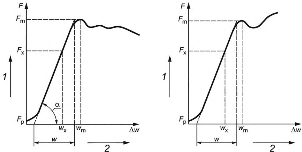
1 — нагрузка; 2 — деформация;  $F_p$  — сила, соответствующая предварительному нагружению;  $F_x$  — линейное значение силы, соответствующее определенной деформации;  $F_m$  — максимальная сила при разрушении;  $w_x$  — линейная деформация образца;  $w_m$  — деформация образца при действии максимальной силы;  $w$  — условная деформация образца при действии максимальной силы;  $\alpha$  — угол наклона условного прямолинейного участка диаграммы
