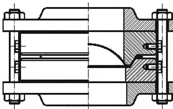
Рисунок 5 — Типовая вставка/держатель капсулы разрывной мембраны
