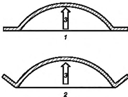
1 — плоская опора, 2 — угловая опора; 3 — направление потока
