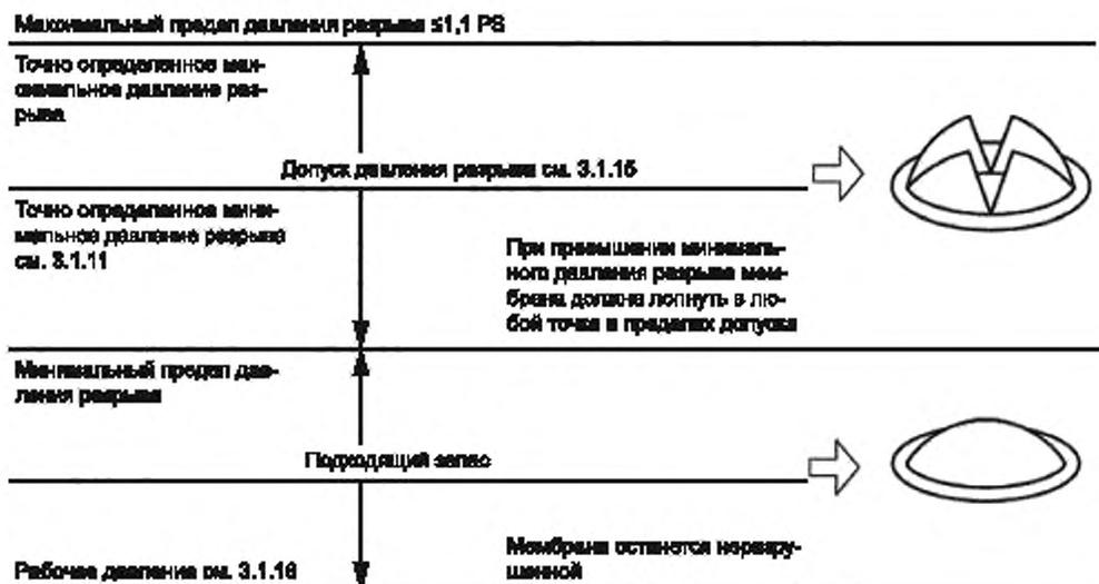
б) Давление разрыва и допуск давления разрыва при соответствующей температуре
