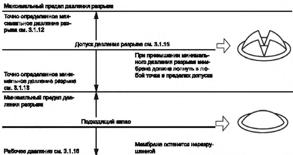
а) Максимальное давление разрыва и минимальное давление разрыва с соответствующей температурой
