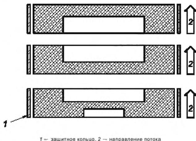
Рисунок 4 — Конструкции разрывных графитовых моноблочных мембран
