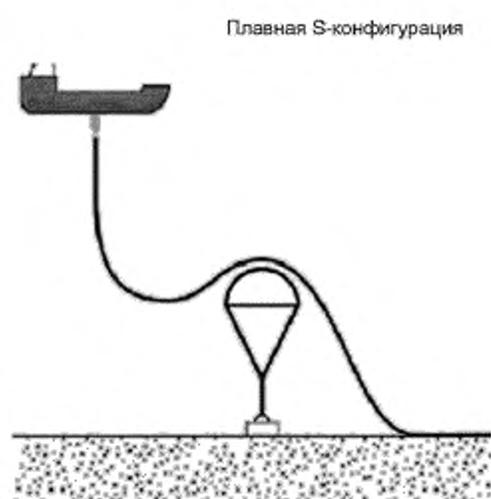
Рисунок 5.15 — Плавная S-конфигурация гибкого трубопровода
