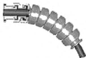
Рисунок 7.15 — Обхватываемая конструкция соединения ограничителя изгиба
