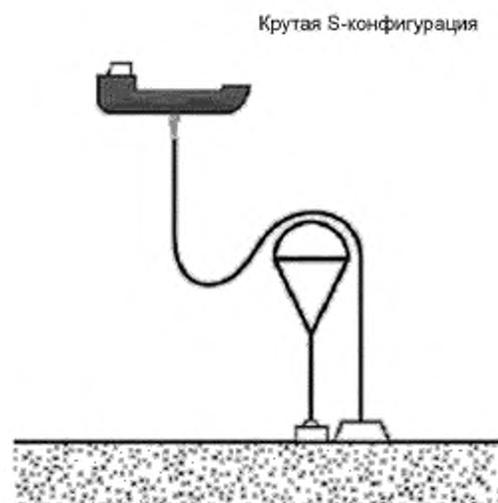
Рисунок 5.16 — Крутая S-конфигурация гибкого трубопровода
