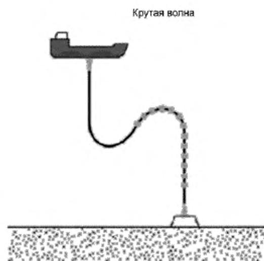
Рисунок 5.11 — Конфигурация гибкого трубопровода в виде крутой волны
