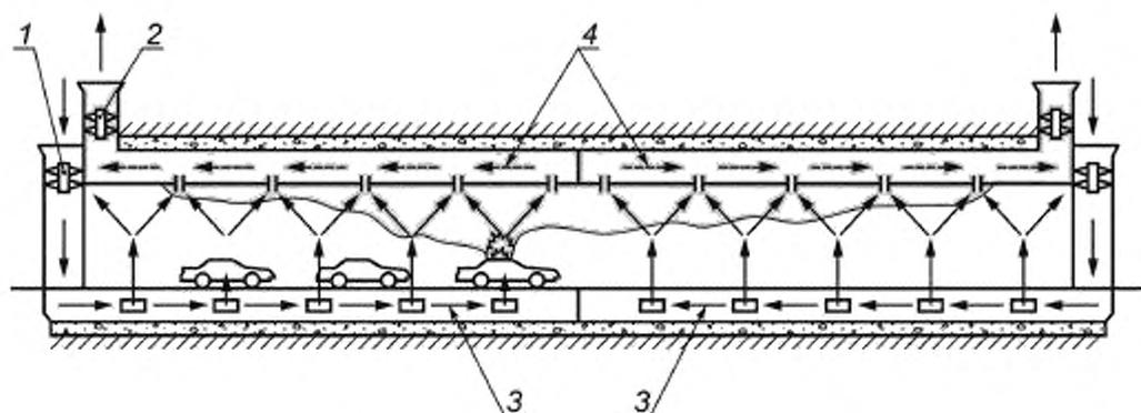
1 — нагнетательный вентилятор с приводом; 2 — вытяжной вентилятор с приводом;
