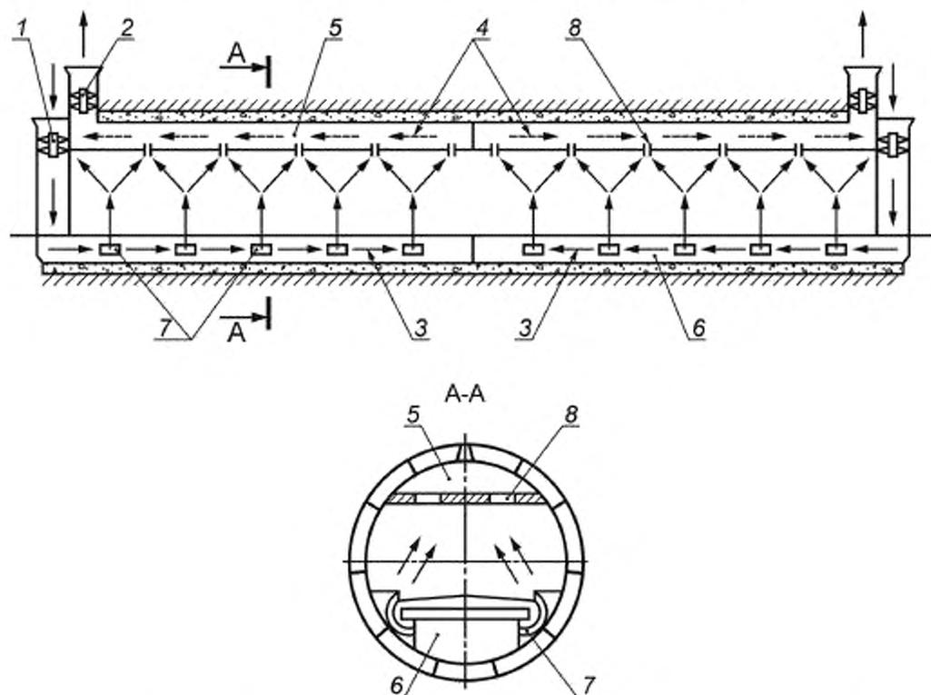
1 — нагнетательный вентилятор с приводом, 2 — вытяжной вентилятор с приводом; 3 — направление движения свежего воздуха, 4 — направление движения загрязненного воздуха; 5 — вытяжной канал; 6 — приточный канал; 7 — поперечный канал, 8 — отверстие в вентиляционной перегородке
