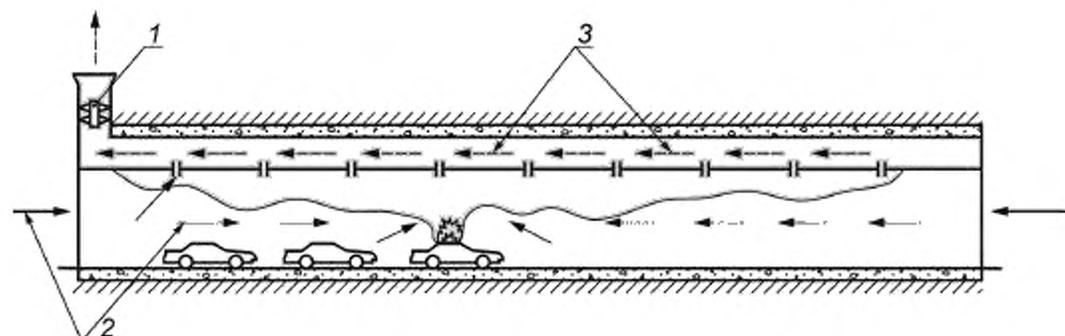
1 — вентилятор с приводом; 2 — направление движения свежего воздуха;
