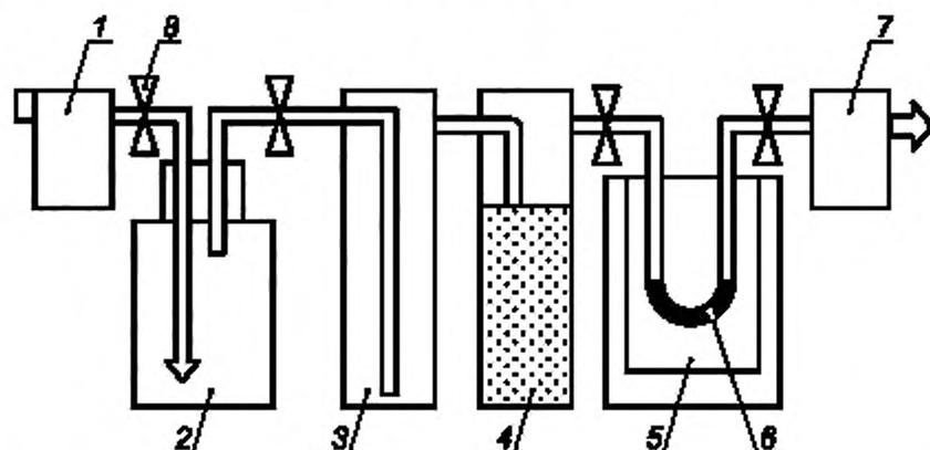
1 — ротаметр; 2 — емкость с пробой воды; 3 — буферный барботер; 4 — барботер с серной кислотой;
