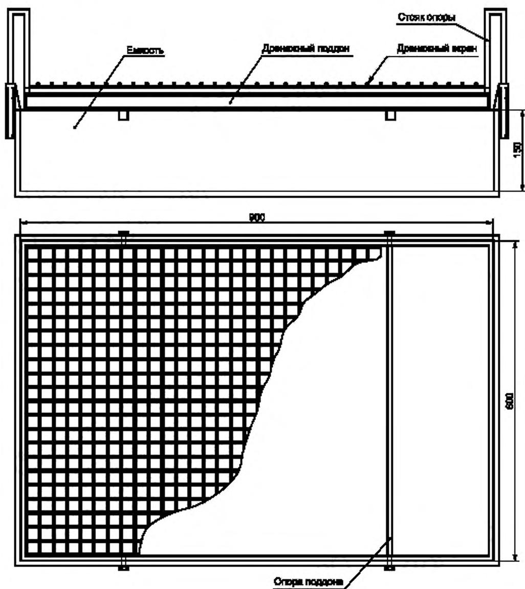
Рисунок 1 — Устройство для определения абсорбционной способности
