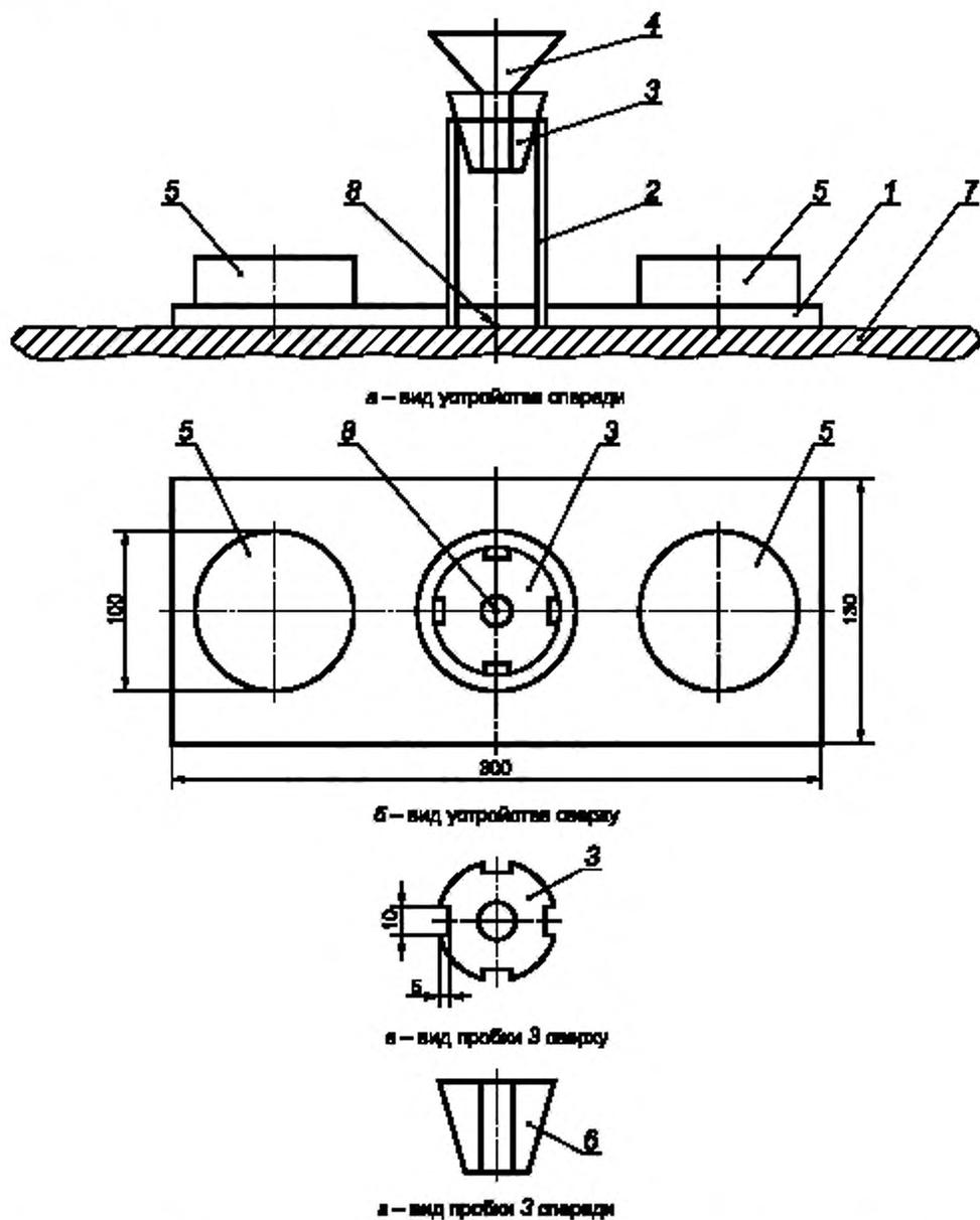
1 – прозрачная пластина; 2 – трубка из прозрачного стекла; 3 – пробка; 4 – воронка из прозрачного кварцевого стекла или пропилена; 5 – грузы массой (2000 ± 50) г; 6 – прорезь в пробке (для оттока воздуха); 7 – бельё; 8 – точка введения раствора в бельё
