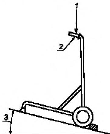
1 — нагрузка; 2 — передняя контрольная точка рукоятки; 3 — угол наклона
