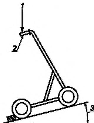
1 — нагрузка; 2 — задняя контрольная точка рукоятки; 3 — угол наклона
