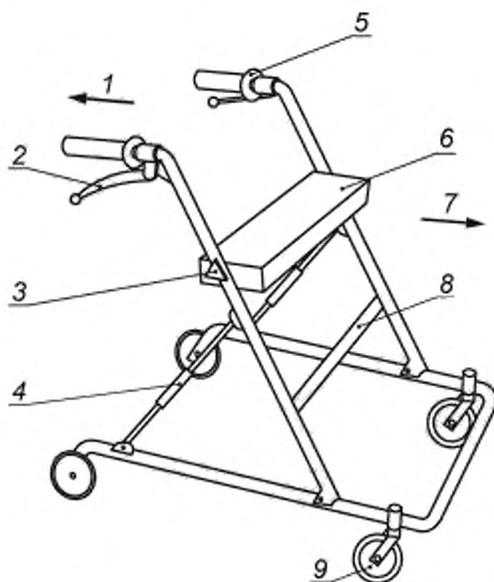
1 — направление назад; 2 — ручка тормоза; 3 — механизм регулирования высоты,
