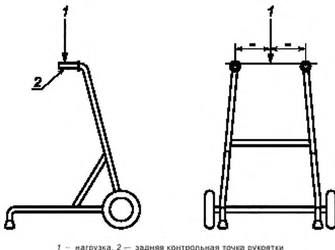
Рисунок 10 — Схема нагружения при испытаниях на усталостную и статическую прочность
