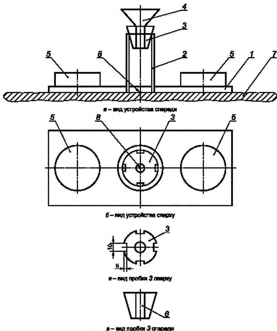
1 – прозрачная пластина, 2 – трубка из прозрачного стекла, 3 – пробка, 4 – воронка из прозрачного кварцевого стекла или пропилена; 5 – грузы массой  $(1000 \pm 50)$  г; 6 – прорезь в пробке (для оттока воздуха); 7 – прокладка; 8 – точка введения раствора в прокладку
