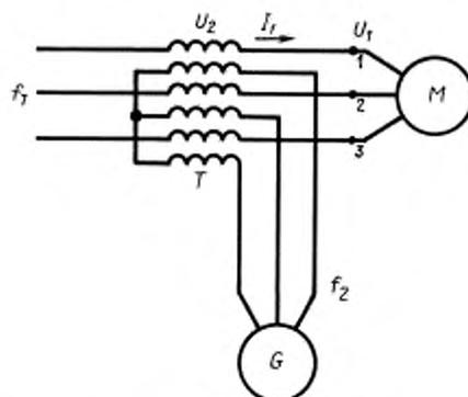
$M$  — испытуемый двигатель;  $T$  — последовательный трансформатор;  $G$  — дополнительный генератор;  $U_1$  — линейное напряжение на выводах двигателя;  $f_1$  — частота основного источника питания (номинальная частота);  $I_1$  — ток статора двигателя;  $U_2$  — дополнительное напряжение питания;  $f_2$  — частота дополнительного источника питания; 1, 2, 3 — точки подсоединения вольтметра, амперметра и ваттметра
