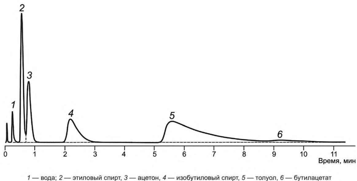
Рисунок Б.2 — Типовая хроматограмма растворителя марки 646
