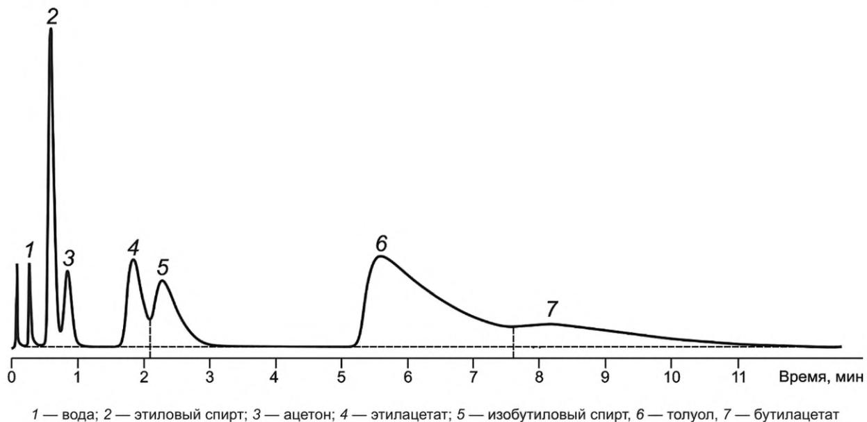
Рисунок Б.1 — Типовая хроматограмма растворителя марки 645
