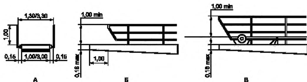
А — ограждение трамплина поперечный разрез; Б — ограждение платформы продольный разрез;
